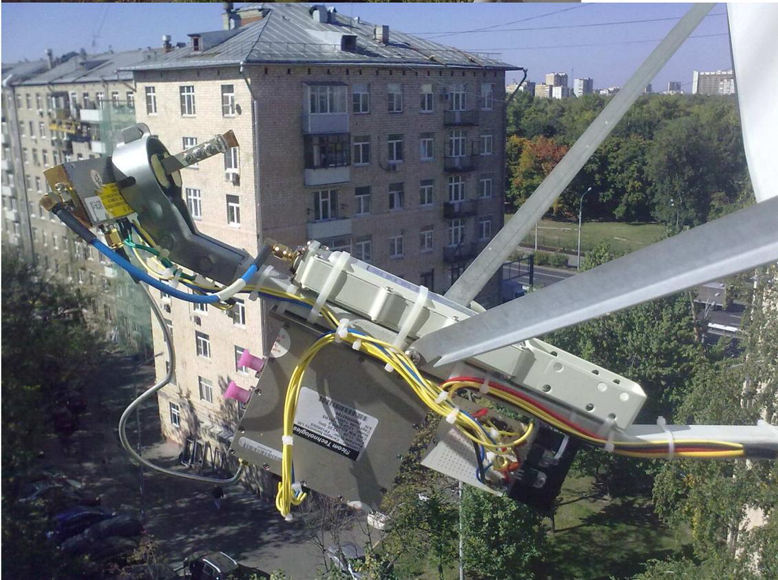
Рис. 4. Антенная часть приемника 38 GHz.
