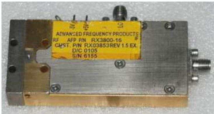
Рис. 5. Приемный модуль 38 GHz.
