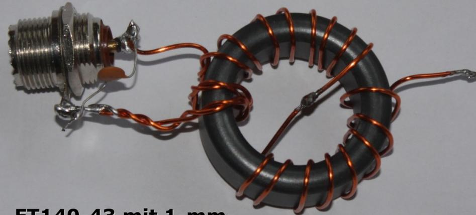
FT140-43 mit 1-mm-Draht für 100 Watt HF
