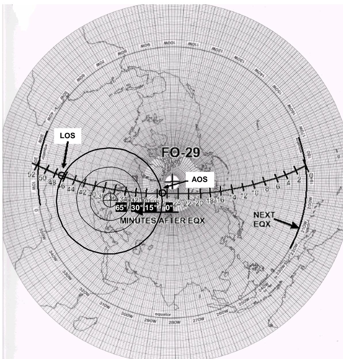
Nous pouvons lire sur le gabarit de couverture l'angle d'élévation à laquelle il faut pointer les antennes en lisant l'angle correspondant aux cercles concentriques. L'angle d'élévation maximum est ici de 60 degrés durant ce passage.
