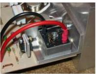
Slike prikazujejo vrstni red montaže. Napetostni regulator in tranzistor se zaspajka v tiskano vezje šele potem, ko je graetz pritrjen z vijakom. V alu L profilu je navoj M4, v ta navoj se privijači vijak M4x25, ki drži graetz, vijak pa je toliko dolg, da na drugi strani tiskanega vezja nanj pride še matica M4, ki dodatno drži tiskano vezje.
