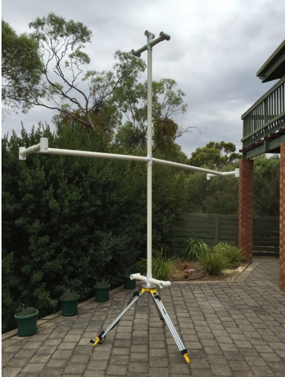
Cada sección del brazo esparcidor de tubería de PVC tiene exactamente 1,5 metros de longitud
