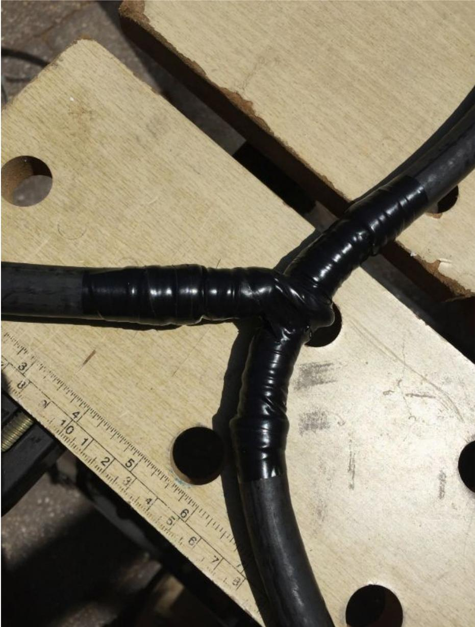
La resistencia a la intemperie se logró mediante el uso de cinta autoamalgamante de caucho con una capa de cinta de PVC estabilizada a los rayos UV para protegerla.
