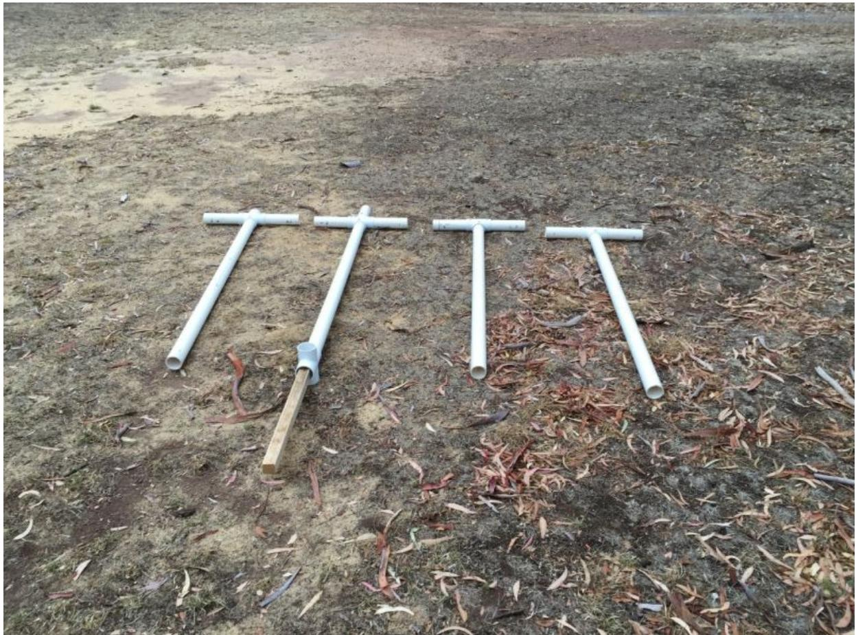
Tenga en cuenta que un trozo de madera se deslizó dentro de la tubería de PVC vertical inferior. Esto era necesario para agregar rigidez a la estructura y funcionó muy bien al hacerlo sin agregar demasiado peso. Las dimensiones de la madera son 40 mm x 40 mm x 2,2 metros.
