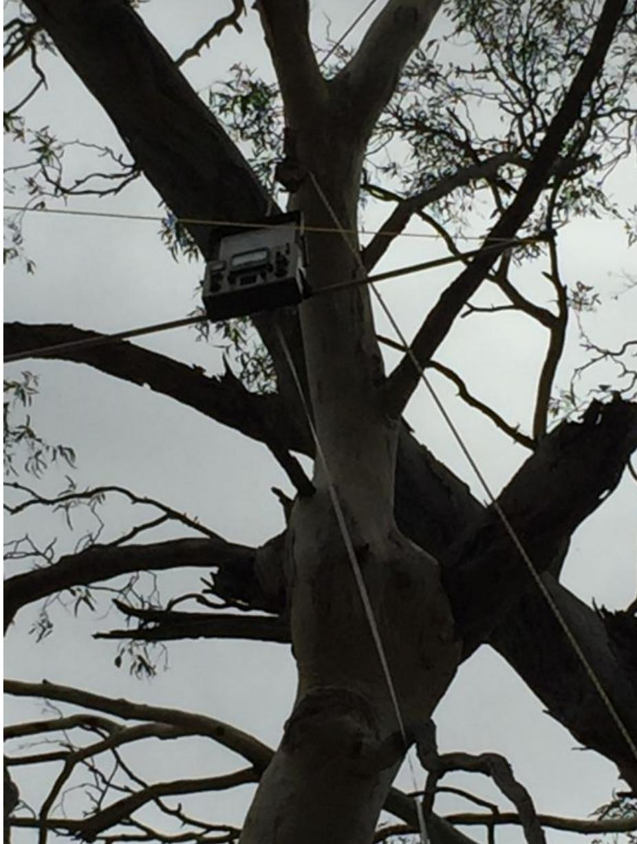
Cuando intentamos medir 45 grados en elevación, usamos un par de binoculares para ver el medidor de intensidad de campo y registrar los resultados.
