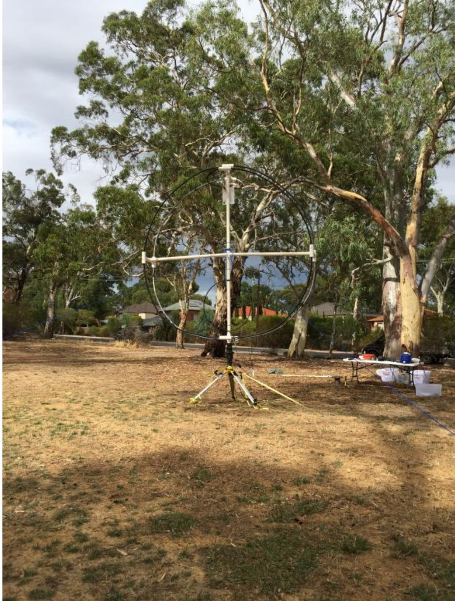
La antena en la posición de prueba. Tenga en cuenta el nuevo bucle primario de 900 milímetros de diámetro.
