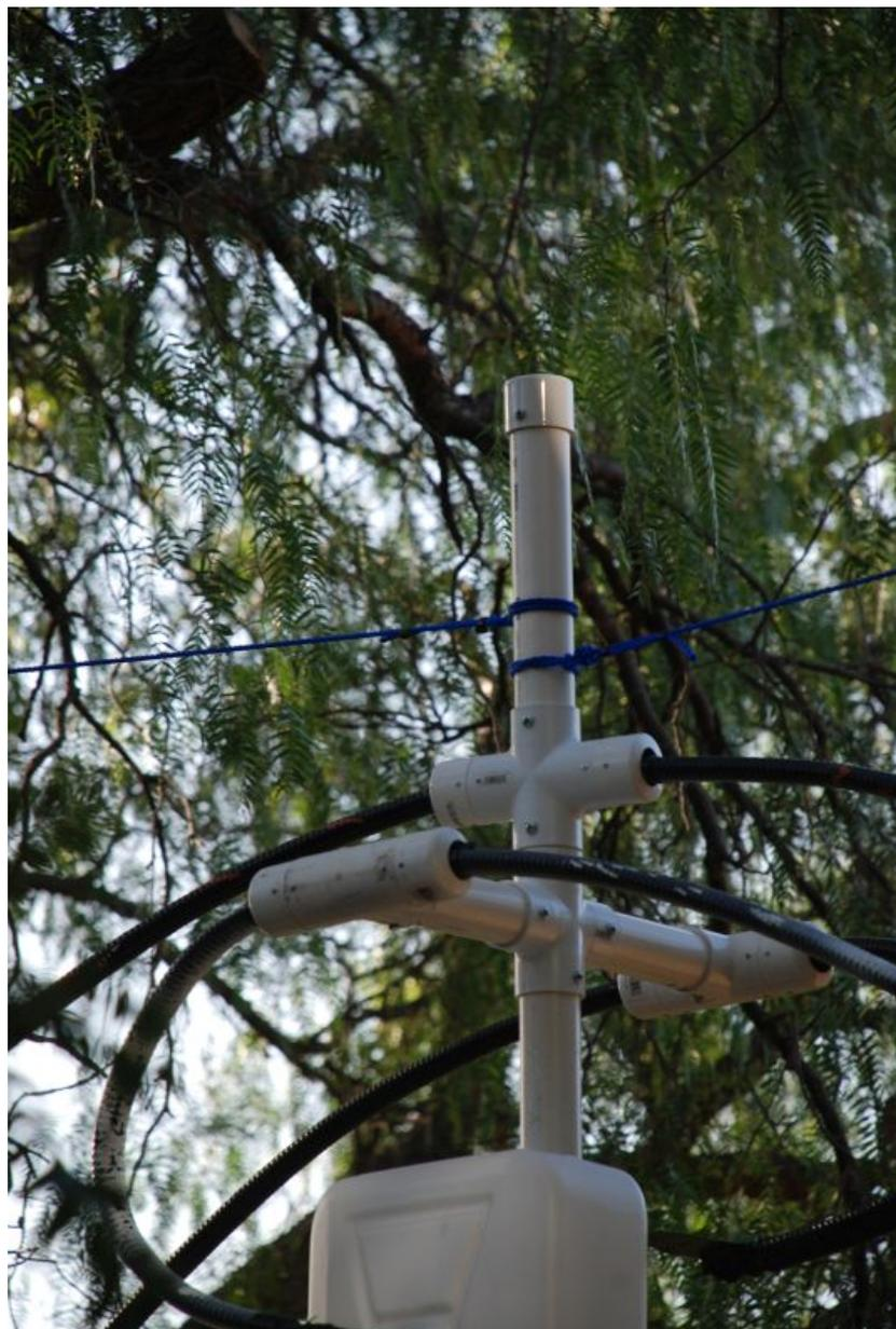
Tenga en cuenta el nuevo tubo de PVC extendido en la parte superior de la antena para permitir que dos de las cuerdas de sujeción despejen la estructura. Esta modificación ahora permite que la antena se gire 180 °. La modificación requirió cambiar la pieza superior en T con una nueva pieza transversal. Se insertó una segunda pieza de madera en el brazo separador superior para agregar soporte estructural. .
