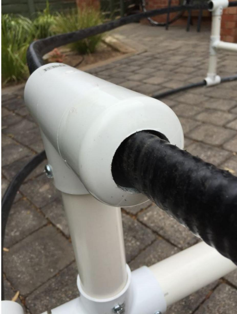
Se utilizaron tapas terminales con un orificio de 38 mm en el medio para apoyar y centrar la guía de ondas.
