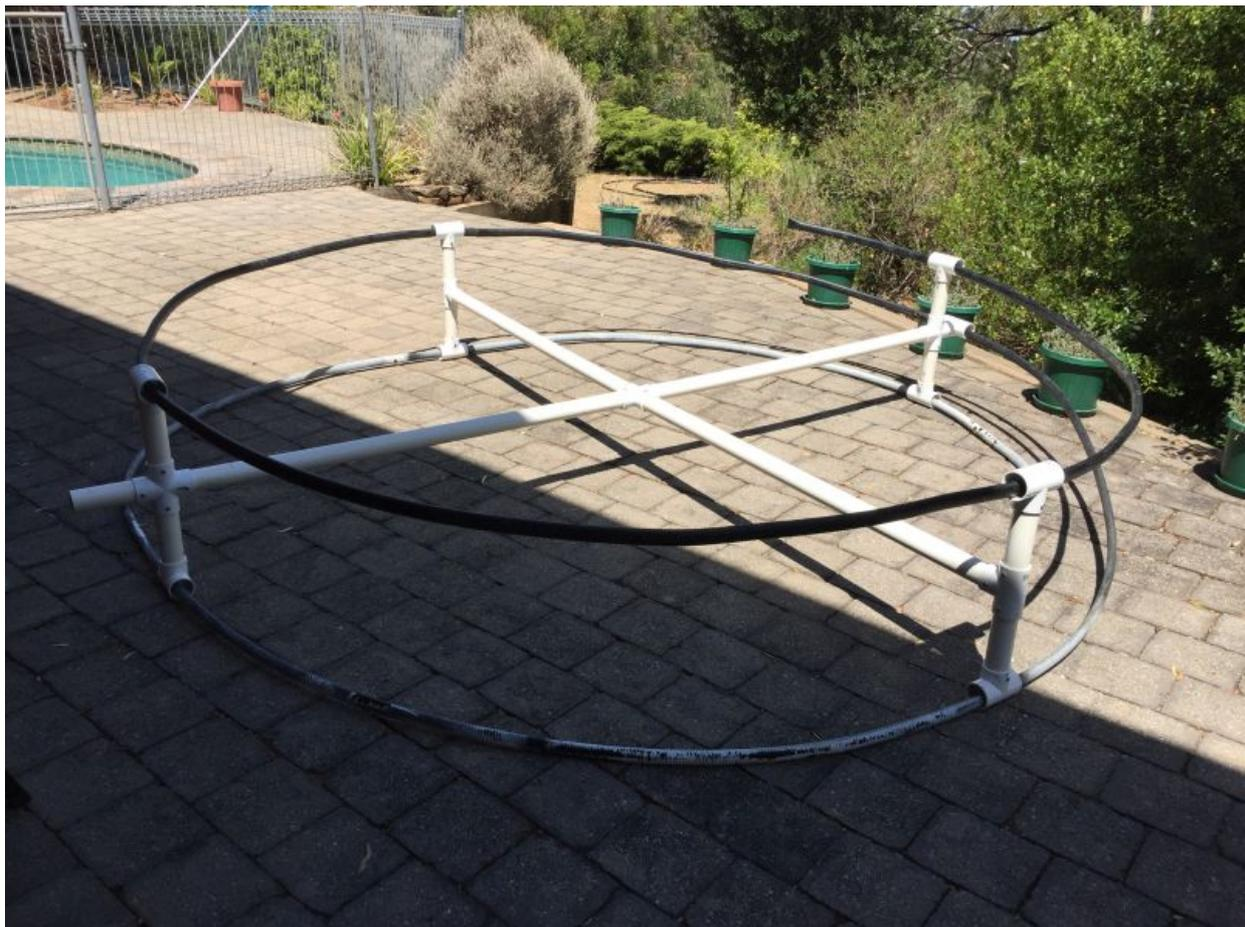
Pruebe el ajuste de la guía de ondas sin las tapas de los extremos colocadas. Se requiere una longitud aproximada de 23 metros.
