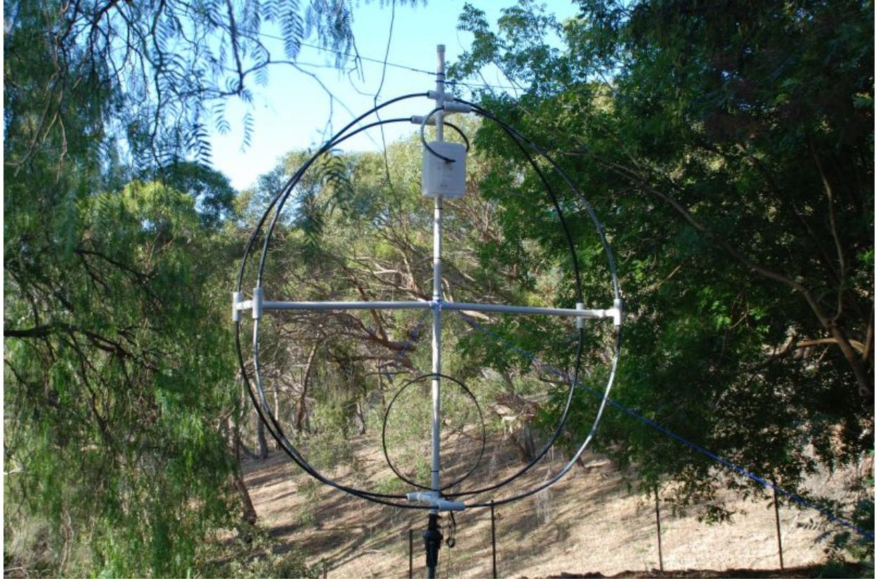
Tenga en cuenta el "bidón" de plástico de 20 litros después de "Cirugía" que cubre el conjunto del condensador de sintonización para protegerlo de la intemperie.
