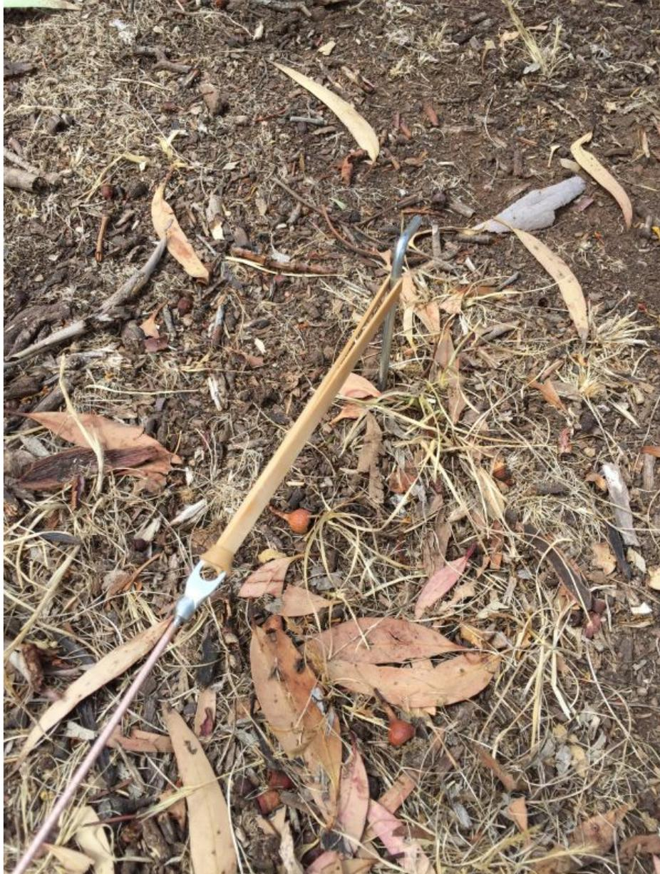
Aislar los radiales del suelo con una goma elástica. Cada radial tenía 10 metros de largo. Los ocho radiales elevados fueron diseñados para desacoplar el TMLA de la tierra.
