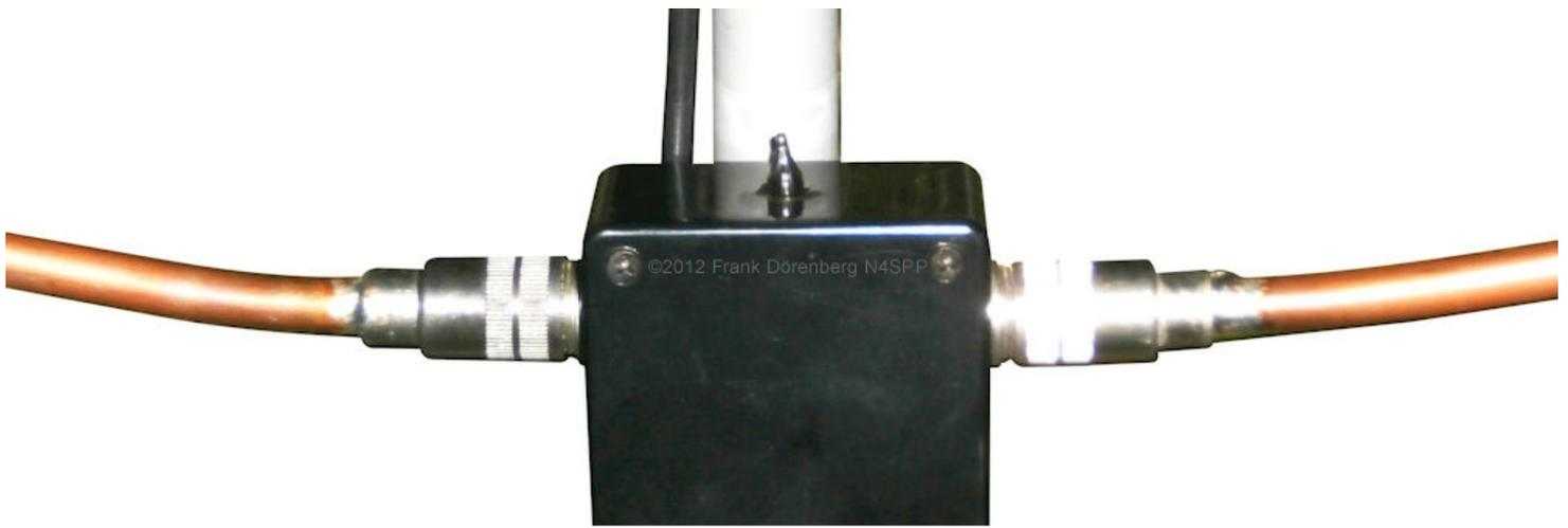
**Fig.13: La lámpara de neón está apagada cuando no transmite en / cerca de la frecuencia de resonancia, y cuando no transmite en absoluto :-)**
