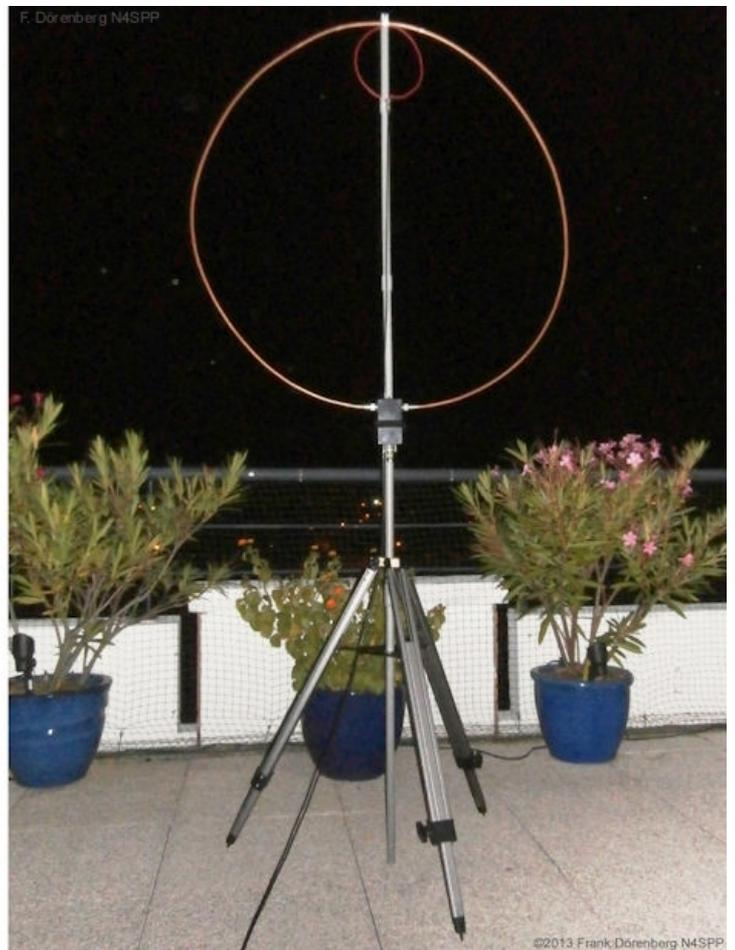
**Fig.16: Mi tercera antena STL - instalada en un trípode**
