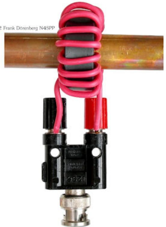
**Fig.26: Acoplamiento de un cable coaxial al lazo con un transformador de núcleo de ferrita**
