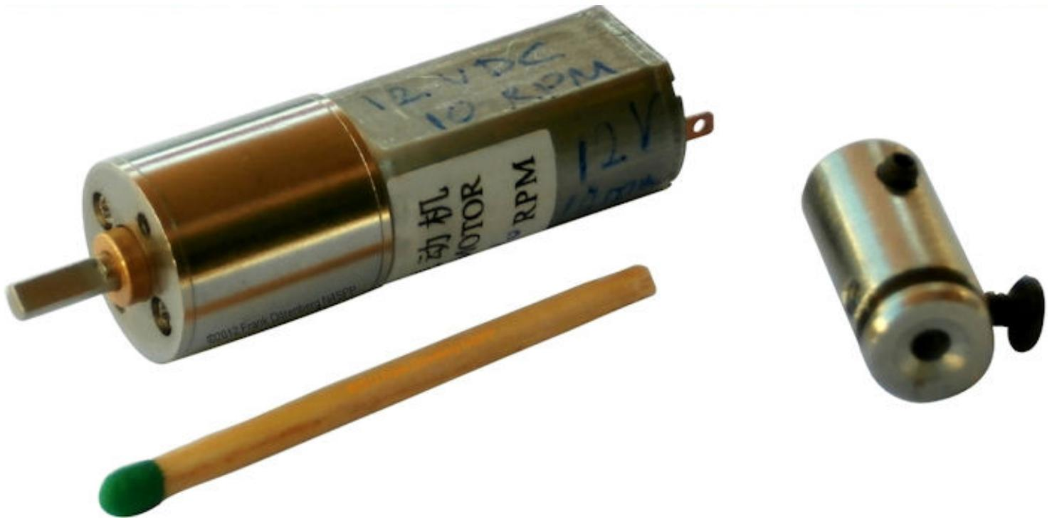
***Fig.17: El pequeño motor de 12 VCC con su engranaje reductor hasta 10 rpm y un acoplador de eje rígido de fabricación casera (de 3 mm a 1/4 de pulgada)***
