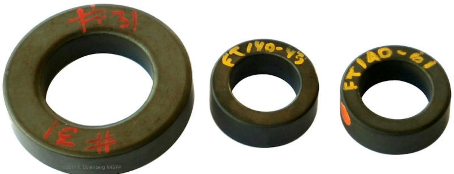
**Fig.25: Núcleos de ferrita toroidal FT-240-31, F-140-43 y T-140-61**
