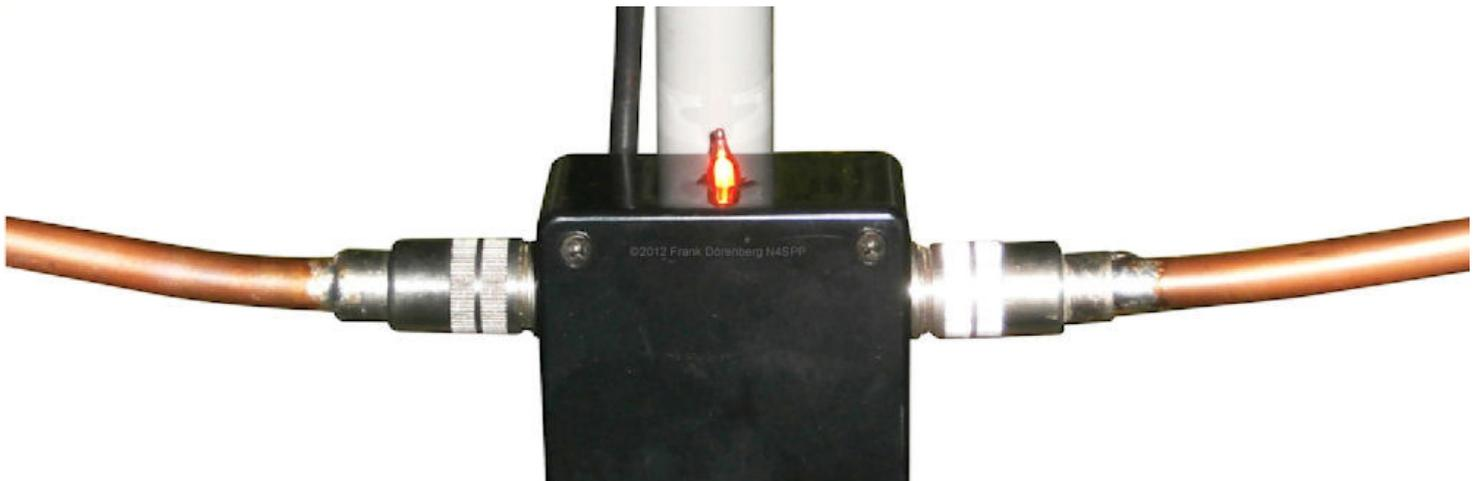
***Fig.12: La lámpara de neón brilla intensamente en resonancia***
