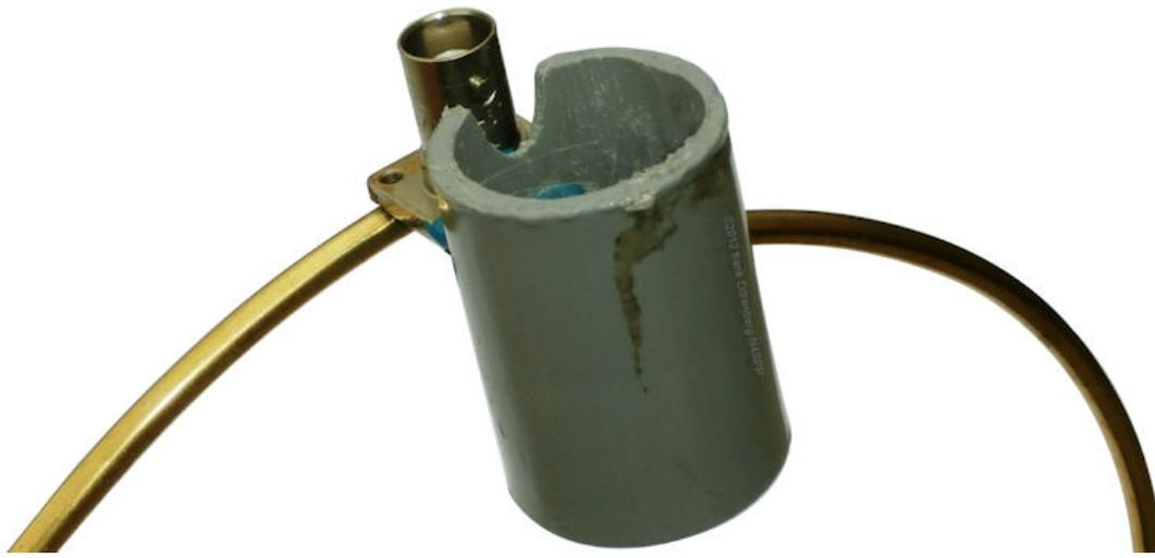
El eje del condensador de sintonización se puede girar sin limitación. El condensador es simétrico, por lo que la capacitancia varía entre el mínimo y el máximo girando el eje 180 grados. El rango de sintonización está muy por encima de los 10 MHz. Debido al alto Q de la antena, el ancho de banda de resonancia es relativamente estrecho. Esto hace que sea difícil sintonizar con precisión a mano. Así que agregué un engranaje de reducción de 6: 1 al eje del capacitor.
