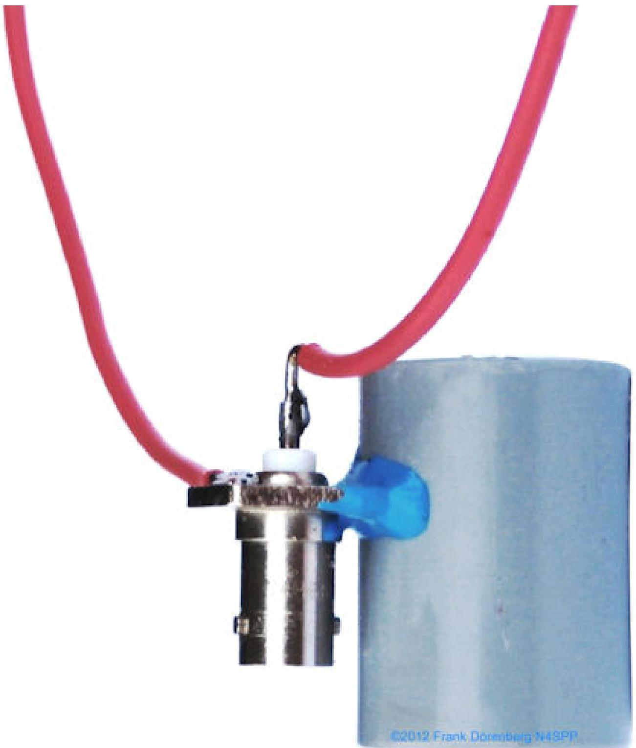
***Fig.6: El conector BNC pegado al acoplador de PVC***
