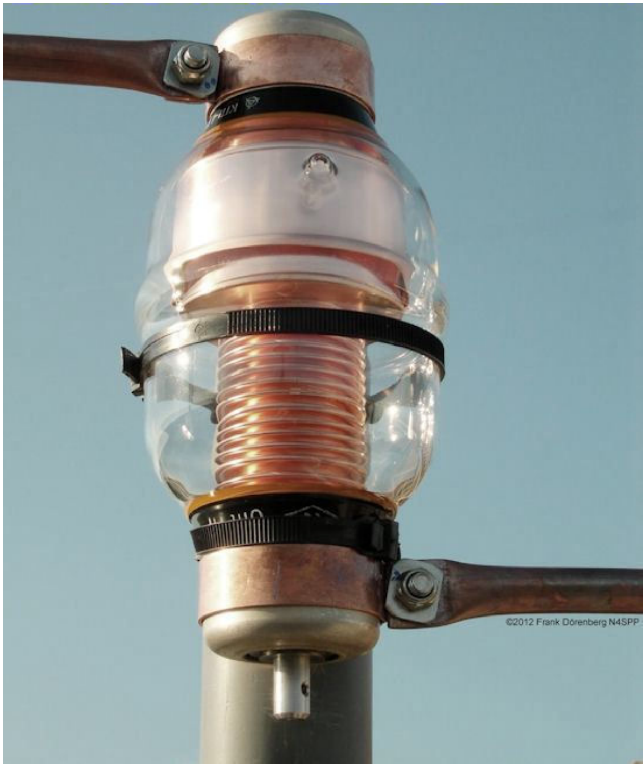
Figura 76: Mi condensador de vacío, conectado al mástil y conectado al lazo
