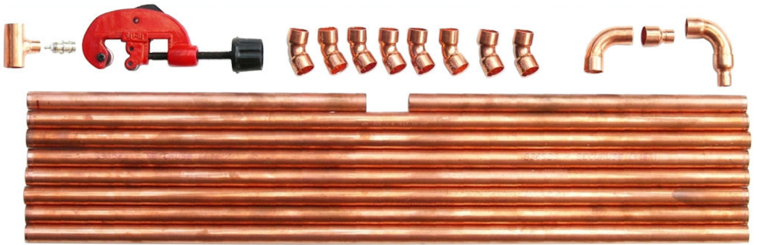
Figura 48: Las partes de "plomaría" de mi antena STL (tubería, piezas de codo, pieza en T) y una herramienta de corte
