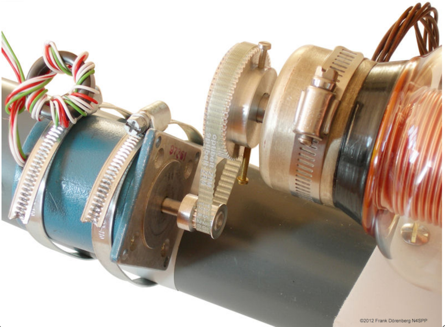
Figura 99: Las poleas y la correa instaladas en el motor y el condensador (observe el "estrangulador" del toroide de ferrita de 5 vueltas en el cableado del motor)
