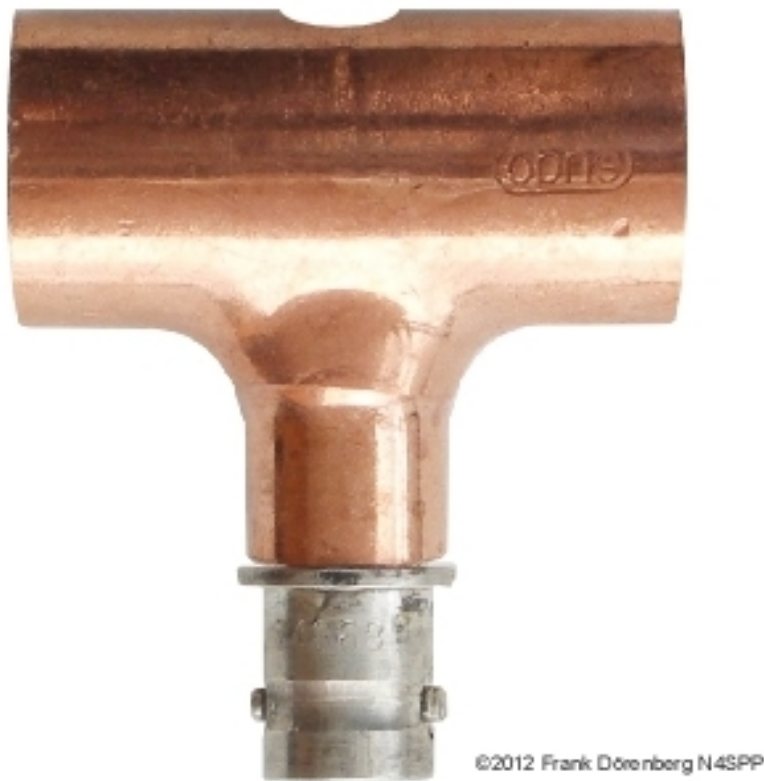
Figura 40: Pieza en T de cobre - insertada en el bucle principal en el punto neutro - con conector BNC
