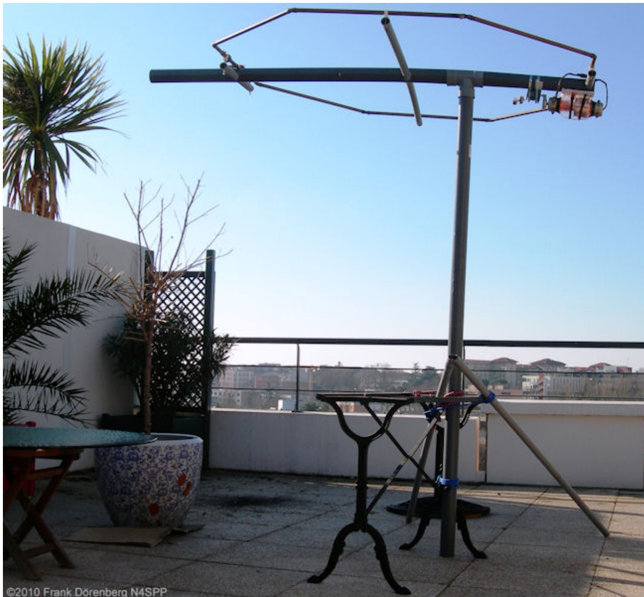
Figura 69: Mi STL, instalado horizontalmente
