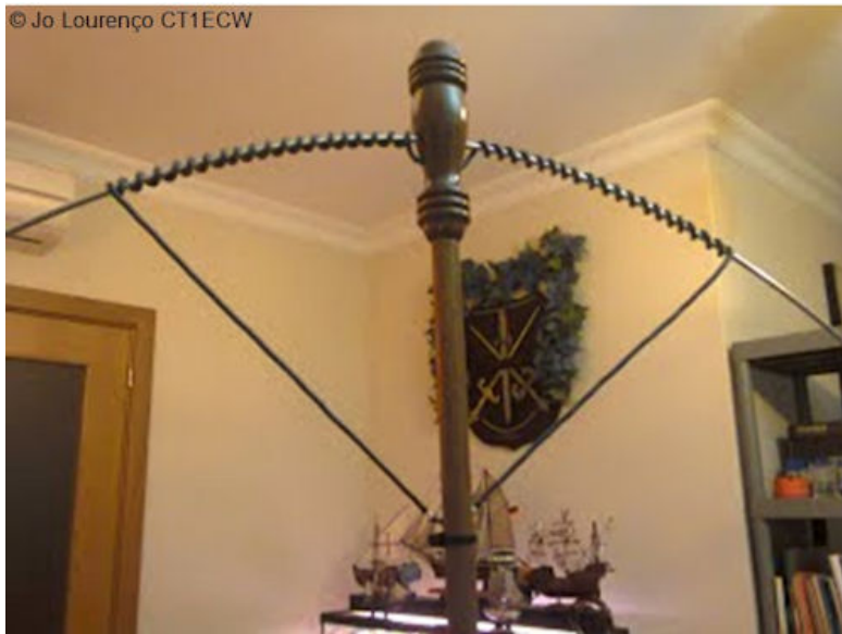
Figura 23: Acoplamiento en espiral (foto: © Jo Lourenço (CT1ECW), usada con permiso)
