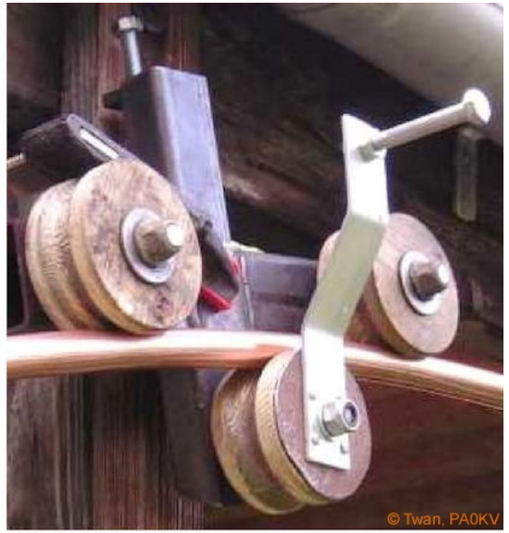
Figura 73: Una robusta dobladora de tubos fabricada por Twan van Gestel (PA0KV)
