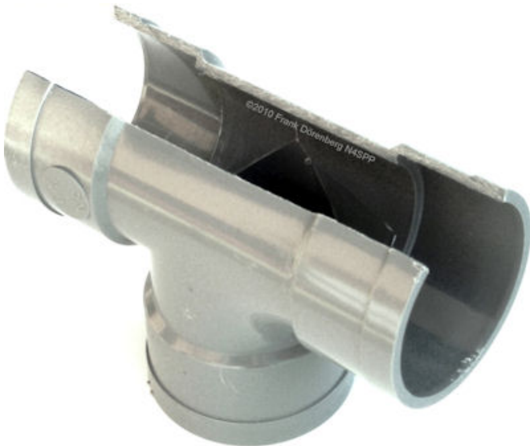
Figura 70: La pieza en T de PVC modificada
