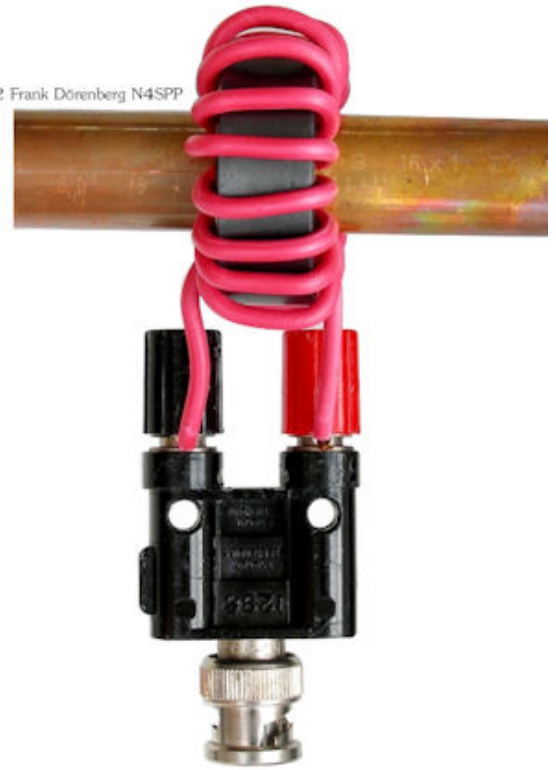
Figura 32: Acoplamiento de transformador 1: N con núcleo de ferrita
