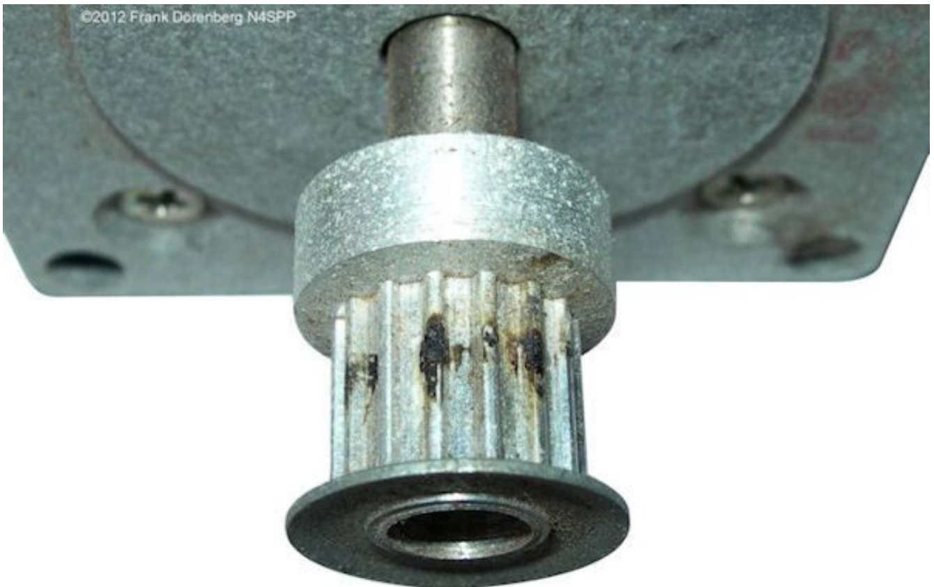
Figura 101: Daño por arco eléctrico en la polea del motor paso a paso
