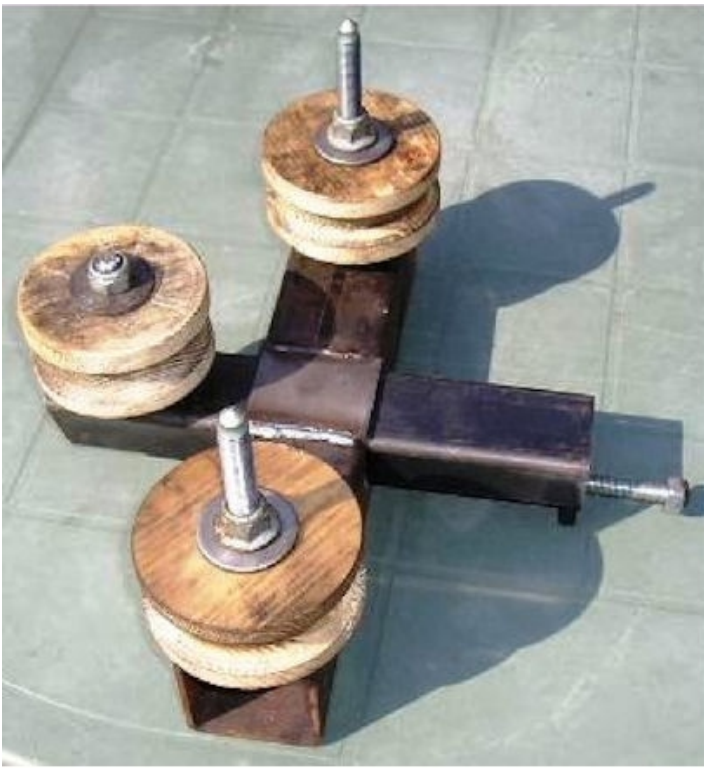
Figura 73: Una robusta dobladora de tubos fabricada por Twan van Gestel (PA0KV)
