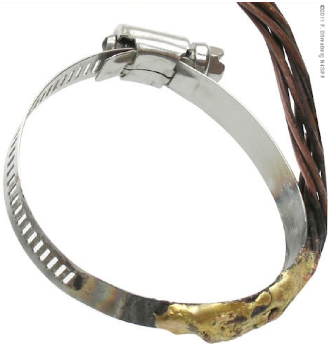
Figura 56: Primer plano de la abrazadera de la manguera con el alambre grueso soldado sobre ella
