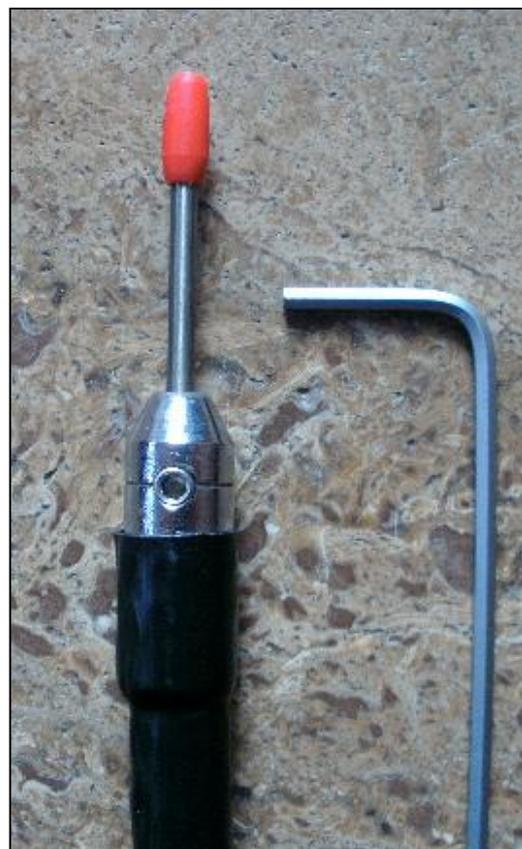
Agrandissez le trou central de l'embout à 8mm, sur une longueur de 6 à 10mm, et soudez-le au tube en laiton.
