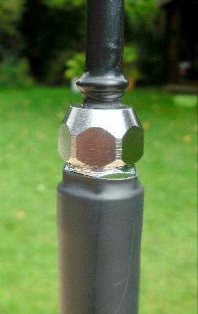
Enfilez une gaine thermorétractable de 12mm jusque contre le tube en cuivre et faites-la rétrécir au décapeur thermique, à la lampe à souder ou au réchaud à gaz (prudence pour ne pas brûler la matière plastique). Coupez à quelques millimètres de l'extrémité de l'embout à l'aide d'un cutter, comme pour dénuder un fil électrique
