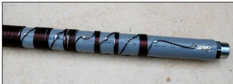
*Les bobinages pour les bandes de 10 à 30m. En réalité, le bobinage pour une bande donnée est constituée par la somme des inductances des selfs situées au dessus. Il s'agit donc d'une self fractionnée.*
