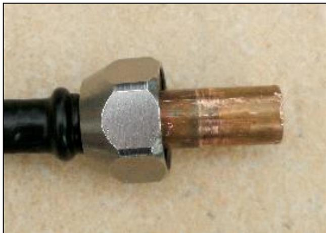
C'est un tube en laiton de 8mm qui est vendu en longueurs de 1m. Coupez-le à 65cm. Polissez une de ses extrémités avec du papier émeri. Sur cette extrémité, enfitez un bout de tuyau de plomberie en cuivre de 10mm. Son diamètre
