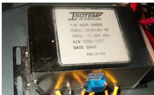
Fig 6 ISOTEMP 10MHz TXCO ref oscillator (den blå 10K trimmeren er 10MHz fin justering.)
