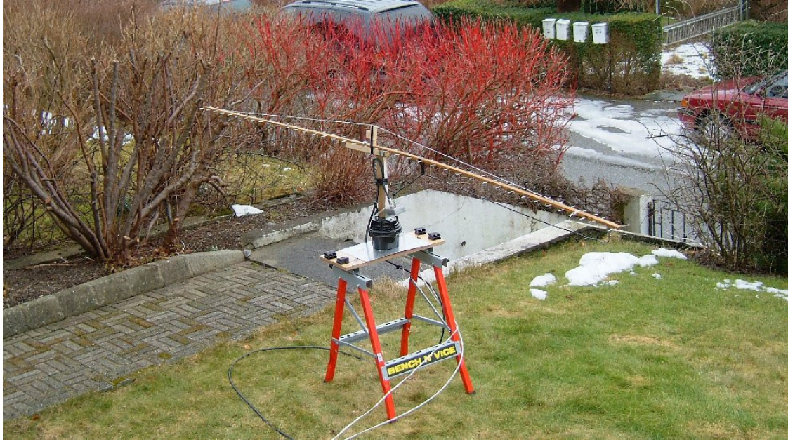
Fig28. 1420MHz 44el lang Yagi antenne klar for søken etter spektrallinjen.
