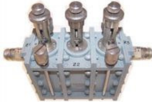
Fig23. Solid båndpass filter for 1420 MHz båndet med N-kontakter.
