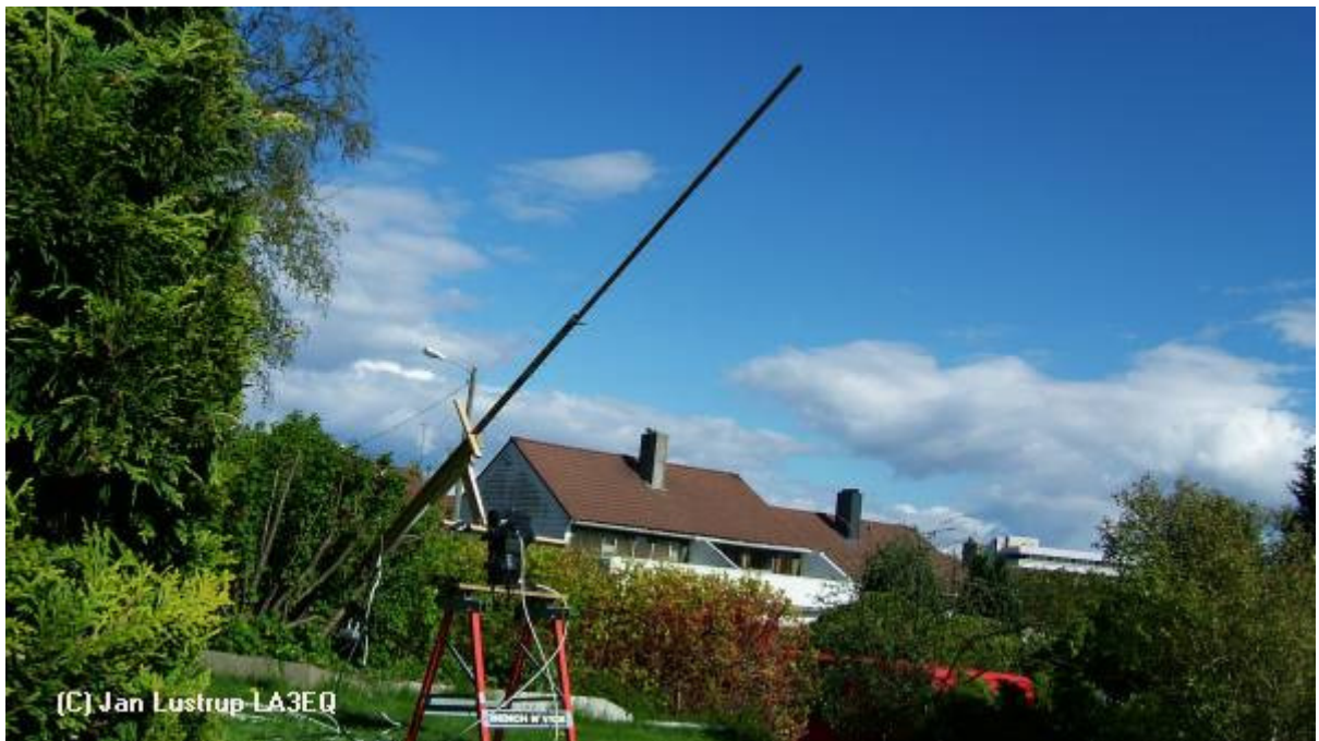
Fig 24. Måling av solstøy i Stavanger på 1296 MHz med hjemmelaget 43 element Yagi og en DEMI 0.4dB HPMT pre amp.
