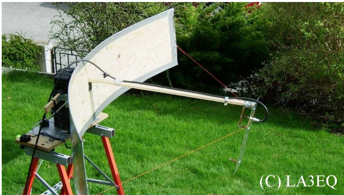
Fig 14. Hjemmelaget pararefleksor for 23cm laget av kryssfiner, duct tape og kjøkken aluminium og utskiftbar fødehode.
