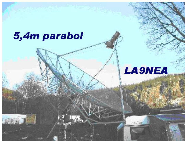
Fig 13. Hjemmelaget EME parabol til Viggo, LA9NEA
