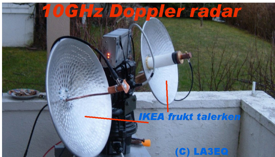
Fig 13. En 10 GHz Doppler radar enhet laget av LA3EQ
