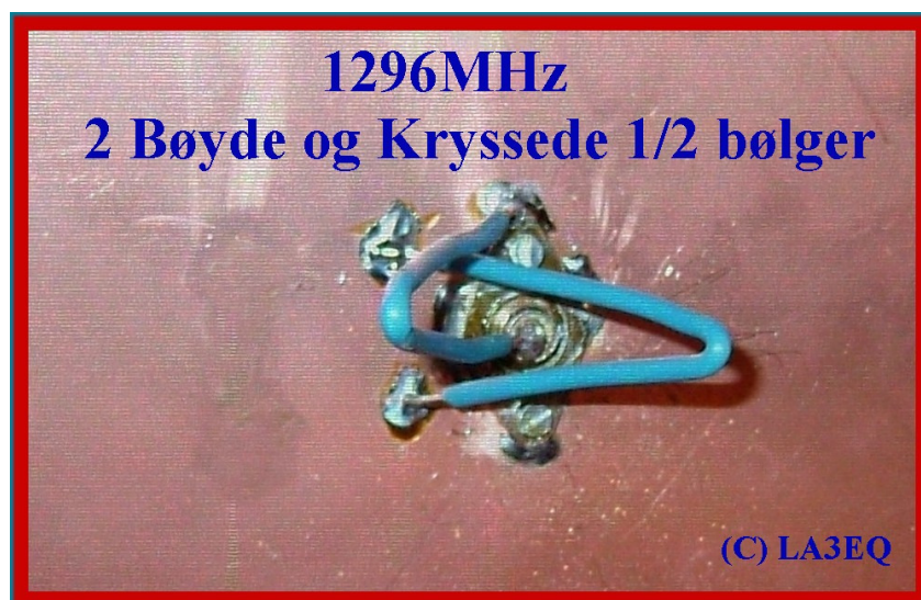
Fig 3 Dobbelt invertet V test antenne skalert til 23cm båndet.
