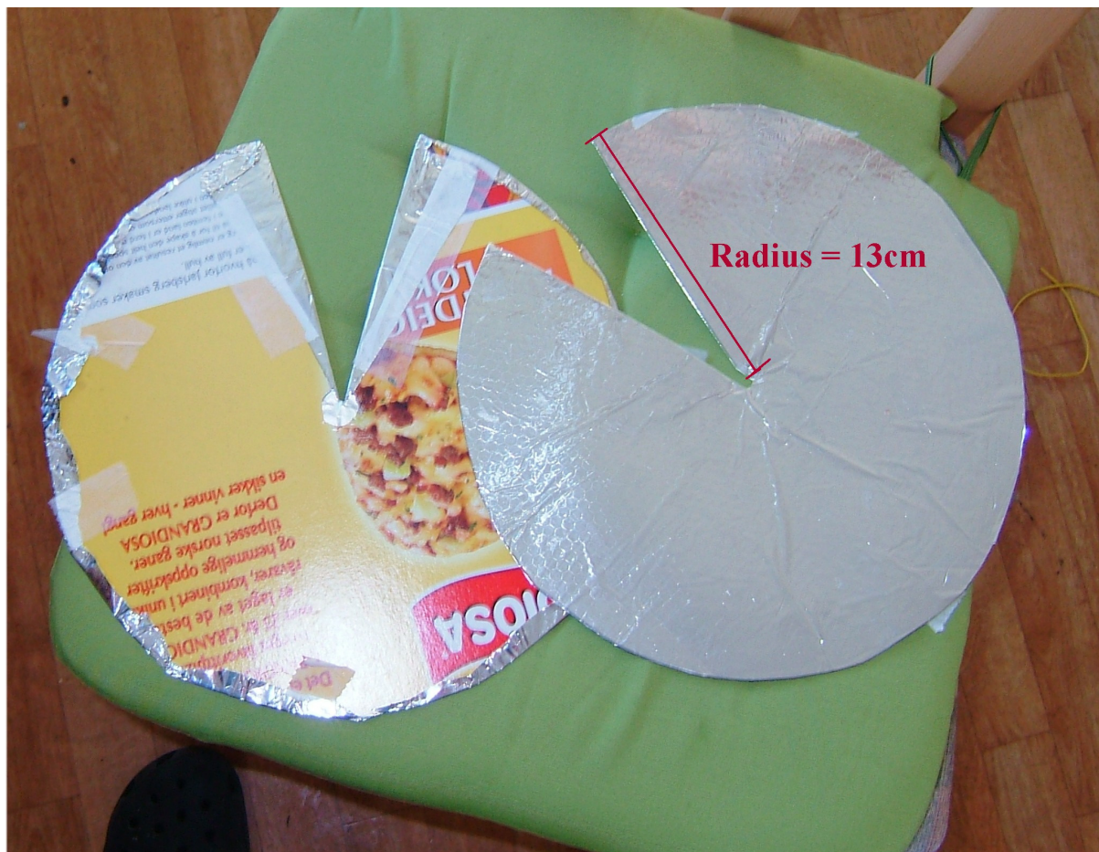
Fig 8 Grandiose pappeske med pålimt aluminiumsfolie. Disse kan klippes i to, og festes rundt kobber launcheren/kollektoren med tape.
