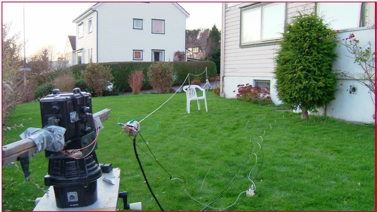
Fig 17. Test oppsett 3 i hagen min. Oppbyggen i midten av strekket hjalp ikke noe på tapet, den økte heller litt!
