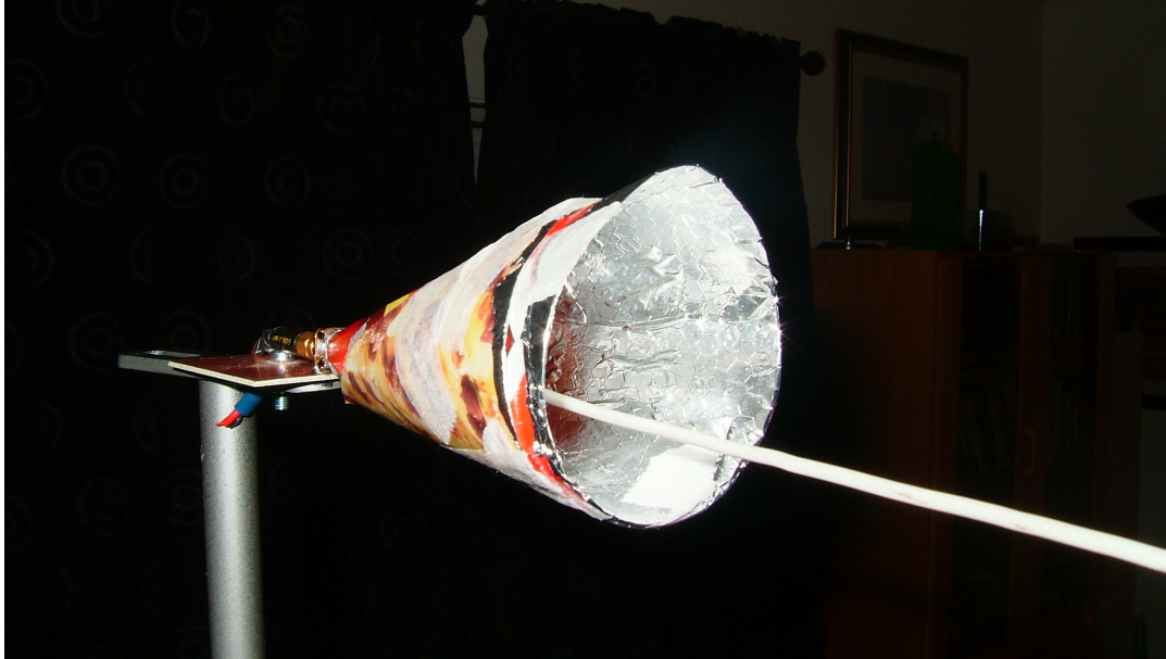
Fig 9. Ferdig forlenget sende horn (Launcher).
