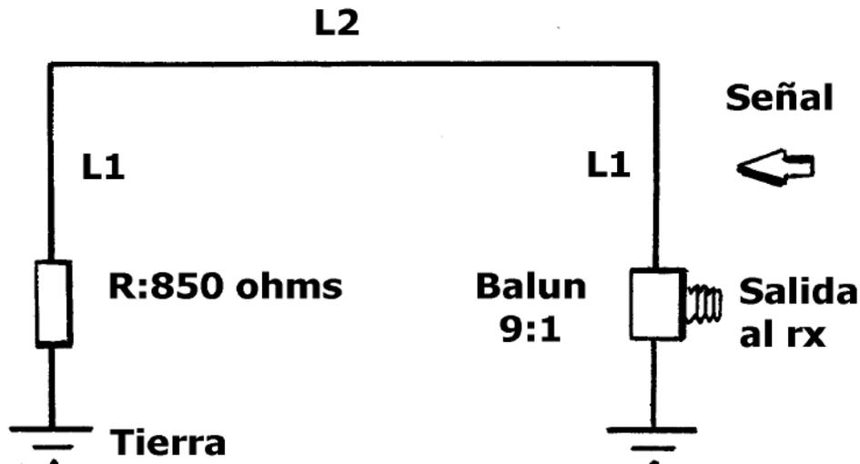
En la figura se muestra la disposición básica de la antena, donde se alimenta a través de un balún 9:1 realizado en núcleo toroide de ferrite en un extremo (desde donde proviene la señal elegida de la emisora) de la que parte la salida de coaxil al receptor y una resistencia de terminación de  $850\Omega$  (aproximados) conectada a tierra en el otro extremo.
