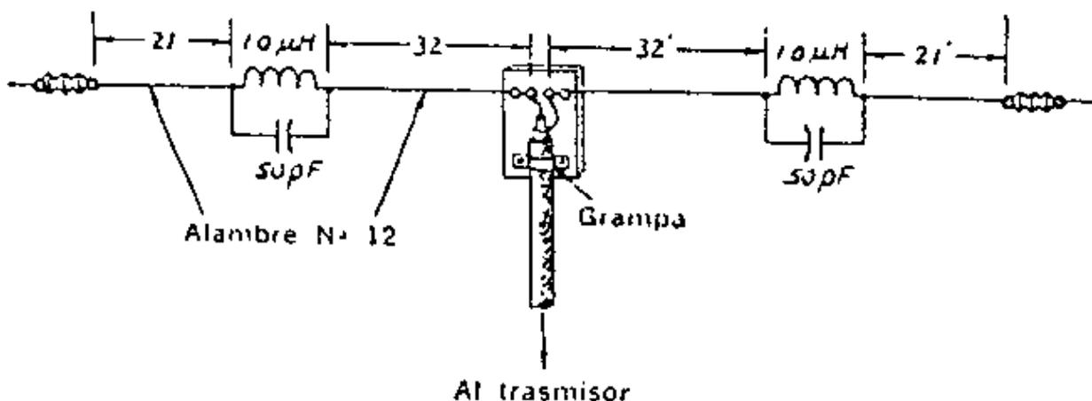
Se alimenta con un coaxil de 52 ohms o línea balanceada de la misma impedancia. Se recomienda esta última solución o mantener el equilibrio del sistema utilizando un balún 1:1 en el punto de alimentación si se prefiere la línea coaxil.
