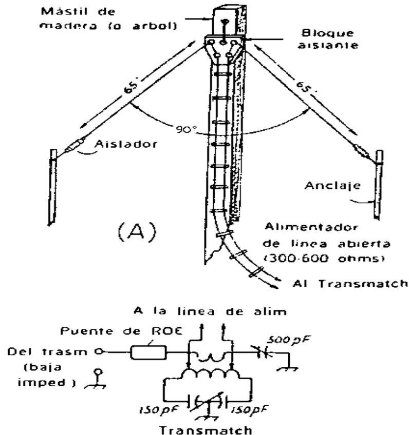
Las antenas de este tipo cortadas para una sola banda y alimentadas con coaxial, requerirán normalmente ciertas manipulaciones para llevarlas a resonancia. Se recomienda la fórmula del dipolo común como punto de partida, aunque como los extremos de la antena están normalmente cerca de tierra en la realidad resultará un poco más corta de lo calculado.
