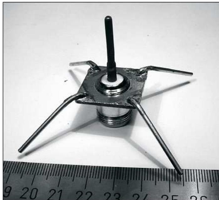
Puede observarse en el gráfico que, a partir de un conector UHF hembra, conocido como SO-239, podemos armar nuestra antena. Los planos a tierra podrán ser soldados a los orificios que posee el conector hembra, que nos servirá de base constructiva y doblados suavemente hacia abajo, dándoles un ángulo a los elementos (planos de tierra) de entre 30 grados (mínimos) hasta 60 grados (máximo).
