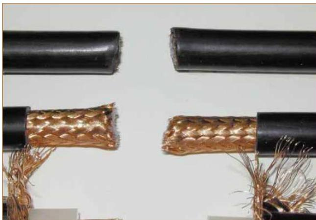
Figura 2: cubierta retirada.
