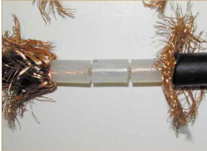
Figura 5: aislante central colocado.
