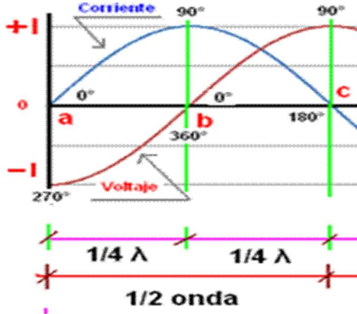
Si a esta fórmula la dividimos entre 2 y la multiplicamos por un factor de acortamiento tenemos que: la longitud física de una antena dipolo de media onda se puede expresar mediante:
