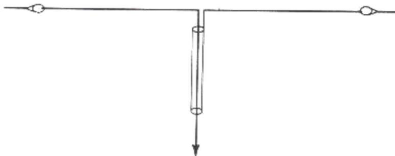
Monobanda simple en V invertida - Polarización vertical
