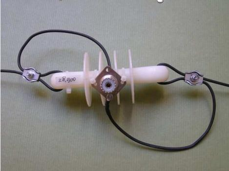
Después se trata de desplegar el hilo la longitud calculada (2,5m) más un pequeño margen (unos 10cm) y pasarlo, en el extremo, por otro aislador idéntico al anterior, donde también se fija con otra brida metálica, igual que hice en el aislador central. El hilo sobrante se fija con precintos de plástico en paralelo al hilo que viene del aislador central.
