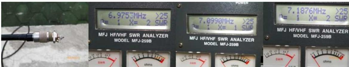
Para cualquiera de los procedimientos anteriores, sugiero comenzar a matchear, en la frecuencia más baja del rango y de ser posible complementar con la mayor indicación RFS alrededor de la antena. Si lo desea, el siguiente medidor RFS de construcción casera ( Improvisado ) lo he sugerido en varios artículos publicados en la WEB, el mismo se construye con material de desecho y de poca importancia en los valores de componentes (no requiere selectividad de frecuencia, solo medir RF).
