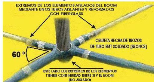
El elemento excitado, por ejemplo, se extiende en un determinado ángulo de la horizontal, inclinado hacia abajo, sube luego
