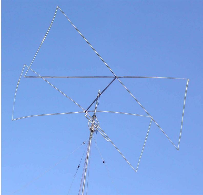
Se fabrican unas cruzetas de trozos de tubo EMT (Conduit metálico), en las cuales se fijan los tubos de los elementos.
