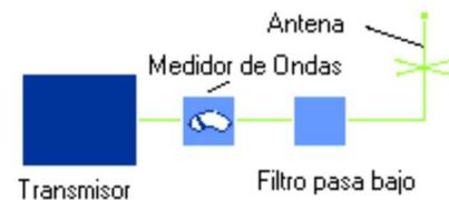
Un filtro de pase bajo bloquea todas las señales por encima de su frecuencia tope establecida, sin cambiar la señal deseada.
