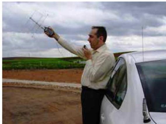
Foto 6 (derecha): estación completa en móvil- portable,  $\frac{1}{4}$  de onda en uplink y 'CJU' en downlink.
