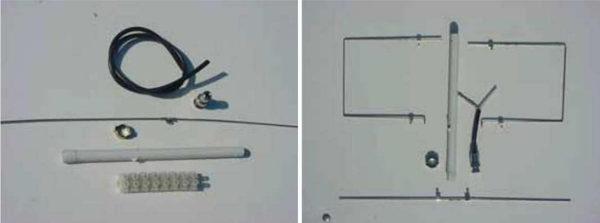
Foto 1 (izquierda): materiales necesarios para construir la antena "CJU".
