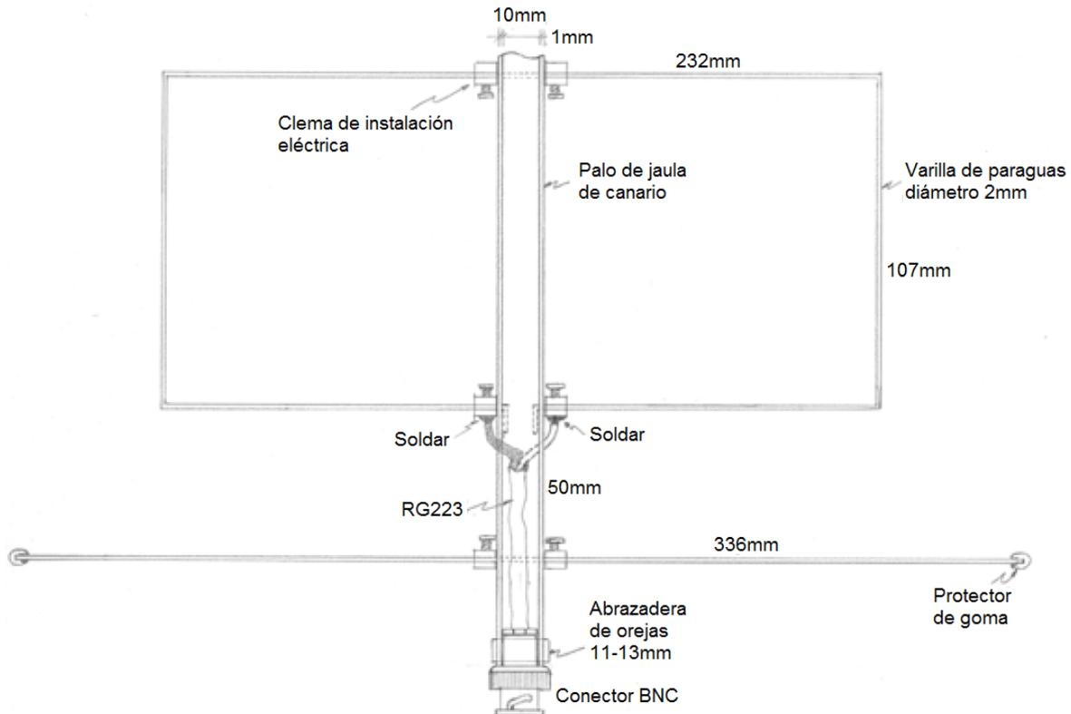
Esquema 1: plano constructivo e la antena 'CJU'
