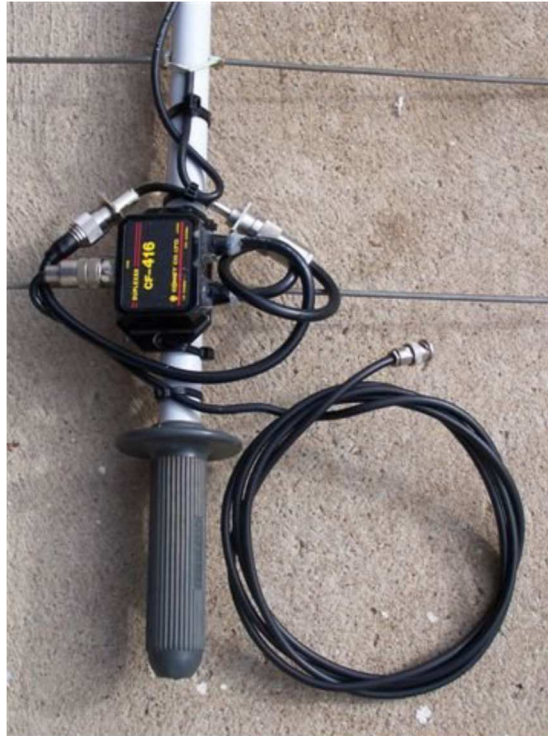
Foto 5: detalle del duplexor.
