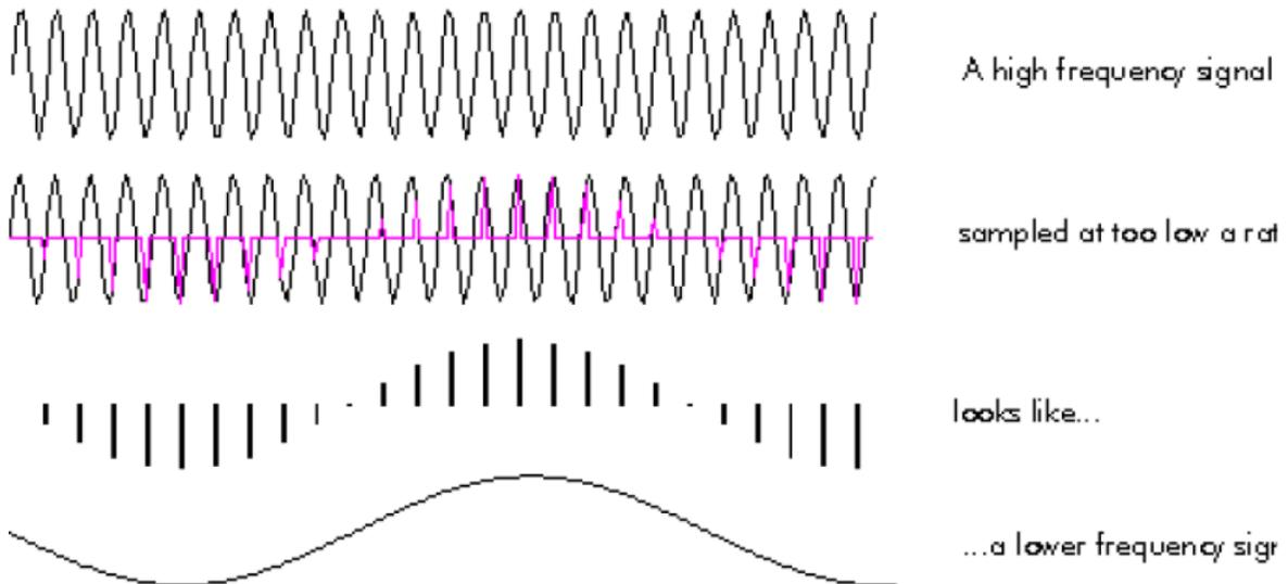
En el diagrama, la señal de alta frecuencia es muestreada aproximadamente dos veces por ciclo, en cada oportunidad ligeramente atrasada en el ciclo respecto de la anterior. Si trazamos una curva que conecte en forma suavizada las muestras, aparece como que la señal tuviera una frecuencia menor. A este
