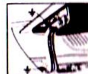
Maadoitusnauha rungon ja konepellin välillä.
