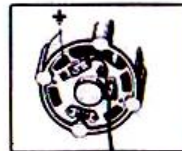
2,2 \mu F rinnakkaiskond. v.v. laturissa erillinen +kytkentä.
