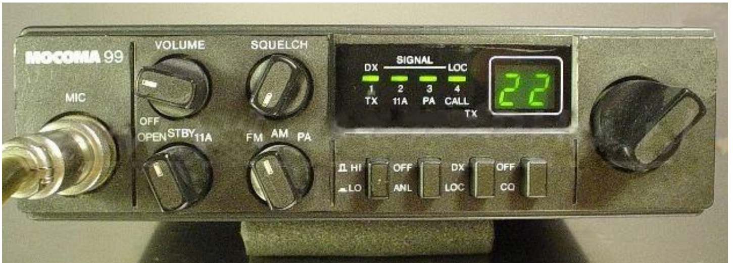
kuva 5. LA-puhelin, jonka sisään on rakennettu selektiivikutsulaite
