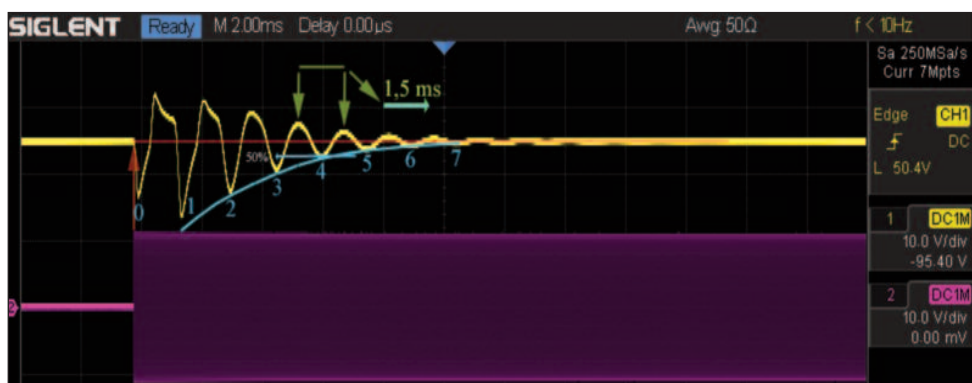
Obr. 1: Oscilogram kliku, který pořídil Pepík na svém osciloskopu. Z obrázku je vidět jasná časová souvislost mezi strmým náběhem výkonu a klikem.
