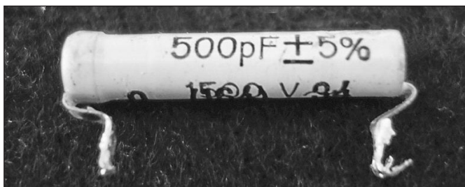
Obr. 5.: Kondenzátor, vzhledově jako nový, měl svod
