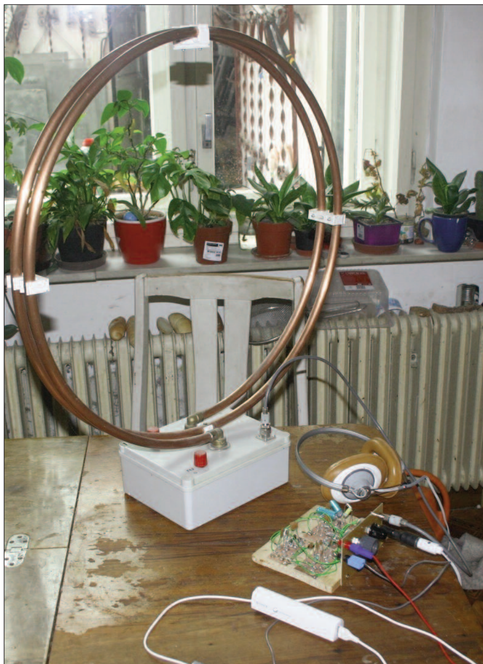
Obr. 20.: Přijímač připojený k magnetické smyčkové anténě - obr. k článku na str. 4
