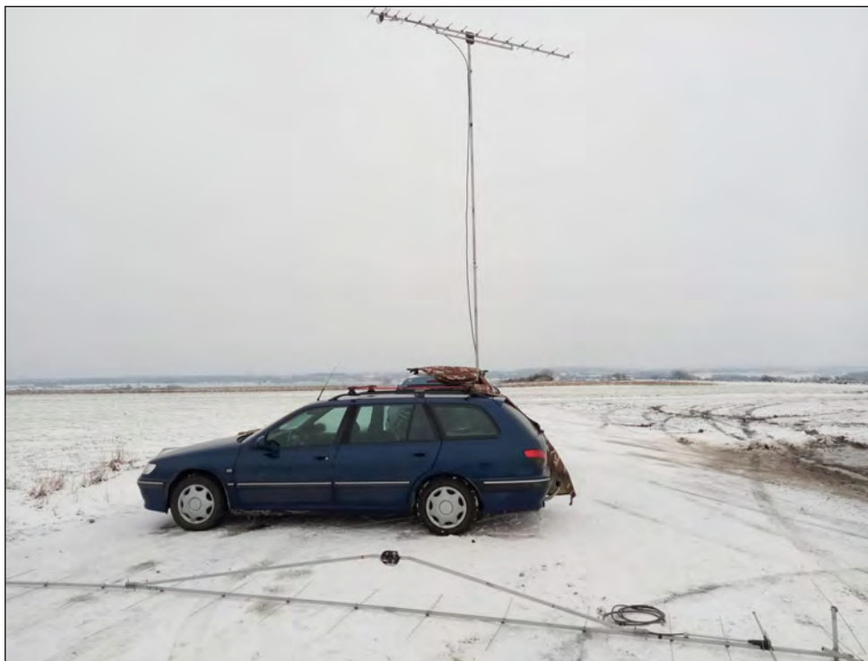
Obr. 3: OK1KUR v lokátoru JN79VX a jejich autoanténa na 70 cm. Anténní stožár stojí vedle auta v přístřešku z plachty. Na zemi ležící anténa F9FT pro pásmo 2 m přijde na řadu v další etapě.
