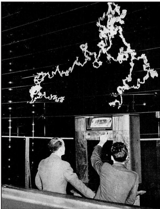
Obr. 2.: Demonstrace odolnosti FM modulace, vůči výbojům statické elektřiny.
