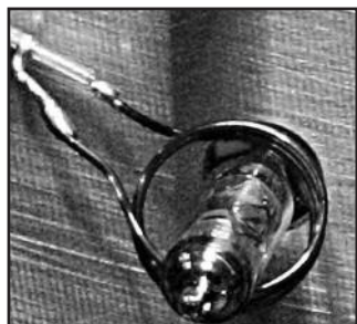
Obr. 5.: Navázání vstupu mf zesilovače na analyzátor NanoVNA
