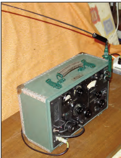
Obr. 11.: Zrekonstruovaný přijímač MwEc s instalovanou anténou
