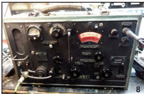
Obr. 6 – 8.: Přijímač Mw.E.c se zdrojem (v levé části) ve skřínce – kufříku
