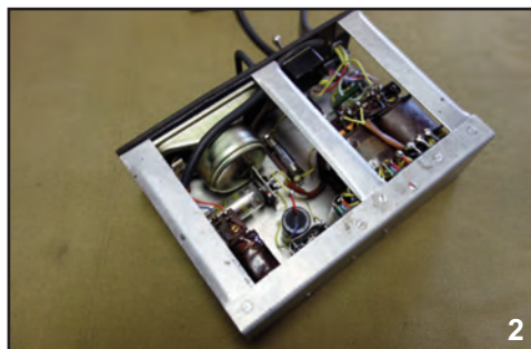
Obr. 1.: Repasovaná skříňka pro přijímač MW.E.c
