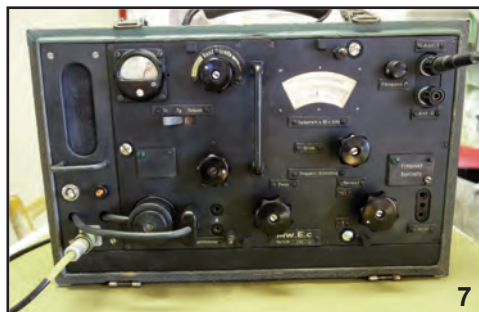
Obr. 6 – 8.: Přijímač Mw.E.c se zdrojem (v levé části) ve skřínce – kufříku
