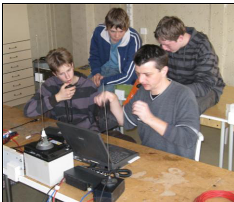
Transceiver Bendix King jsme přeprogramovali pro 145 MHz
