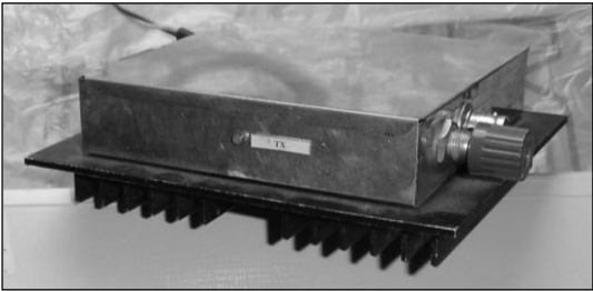
Obr. 3 – Zesilovač ve stínícím krytu a s chladičem >
