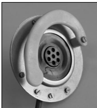
Reproduktor ARZ 098 v plastovém a plechovém krytu je příliš rozměrný, těžký a studí
