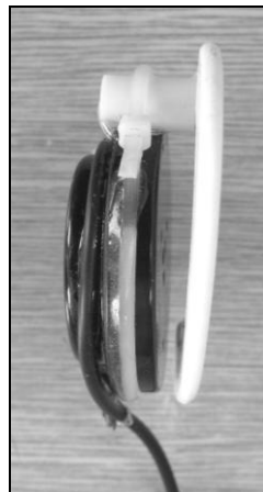
Vojenské sluchátko má potlačené nízké i vysoké kmitočty a proto je vhodné pro poslech CW a SSB. Taky je důležité, že nezkresluje ani při velké hlasitosti
