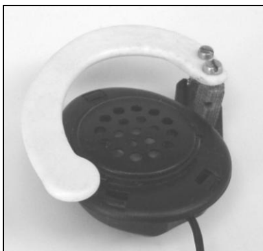
Walkmanové sluchátko se pro svůj široký kmitočtový rozsah hodí pro poslech WFM. Při použití na KV ruší přenášený šum. Výhodou je malá hmotnost
