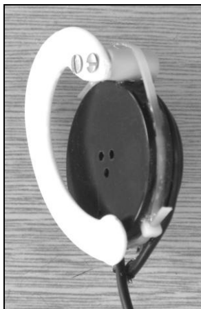
Vojenské sluchátko má potlačené nízké i vysoké kmitočty a proto je vhodné pro poslech CW a SSB. Taky je důležité, že nezkresluje ani při velké hlasitosti
