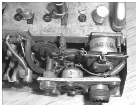
Relay is used after adjusting for antenna relay in 2 m TX in 1963 Relé bylo po úpravě použito jako anténní relé v 2 m TXu v roce 1963
