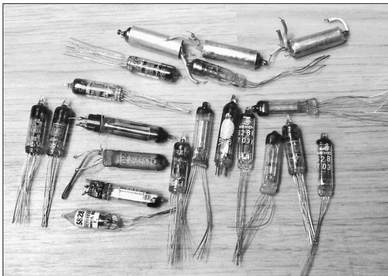
Subminiature tubes used in meteorological sondes in 1950s. Subminiaturní elektronky, používané v meteosondách v 50. letech
