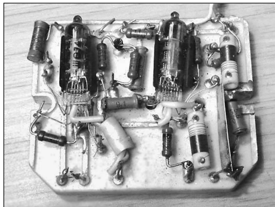
< Construction on ceramics of the Soviet VHF equipment Konstrukce na keramice ze sovětského VKV zařízení
