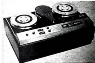
obere Grenzfrequenz 3,2 MHz, und die Spieldauer mit 885 m Videoband beträgt eine Stunde. Bei 4,8 Zoll/Sekunde (12,5 cm/s) Bandgeschwindigkeit liegt die obere Grenzfrequenz noch bei über 2 MHz. Für das neue Bildbandgerät ist von Ampex außerdem ein besonderes Videoband entwickelt worden, das auf 9,5-Zoll-Spulen geliefert wird.
