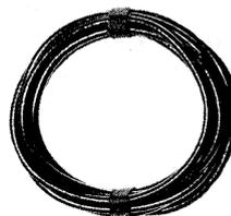
HF-Koaxialleitung Wellenwiderstand 60 Ohm, Innenleiter Kupferdraht, Lupolenisolation, Abschirmgeflecht, PVC-Mantel, Außendurchmesser 3,2 mm, Dämpfung ca. 29 N/km. Empfohlene Abschirmleitung für interne Geräteverdrahtung von Sender- und Empfänger-Antennenleitungen, in Abschnitten von ca. 2 m je Abschnitt 2,50
