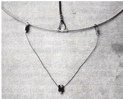
Fot. 1.7.4. Transformator delta
