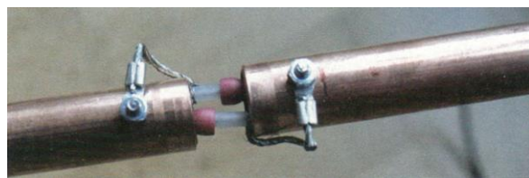
Fot. 1.3.3. Widok podłączonych kondensatorów
