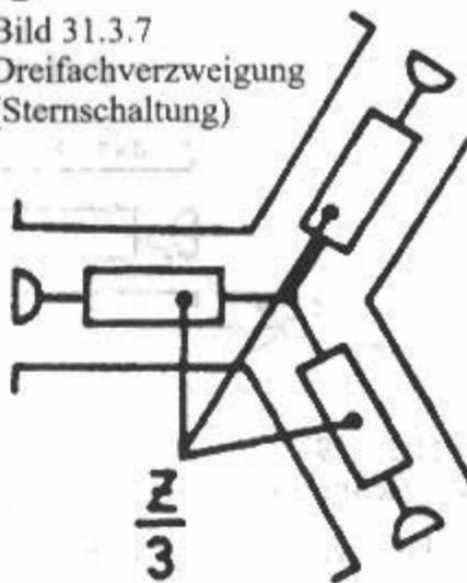
sind die Ausgänge. Der Entkopplungswiderstand ist  $Z/3$ , mit  $Z$  als Wellenwiderstand. Die Durchgangsdämpfung ist ebenfalls  $6 \text{ dB}$ . Man kann die Widerstände auch in Dreieckschaltung ausführen (Sternschaltung  $\longleftrightarrow$  Dreieckschaltung) (**Bild 31.3.8**). Der Entkopplungswiderstand ist dann  $Z$  bzw.  $R$ . Die Durchgangsdämpfung ist hier ebenfalls  $6 \text{ dB}$ .
