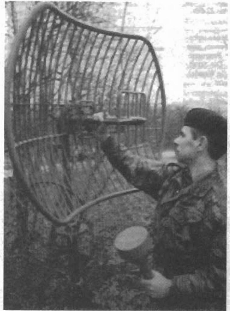
Bild 35.1.13 Militärische Parabolantenne mit austauschbaren Erregern für Band 2 und 3 (CS4)
