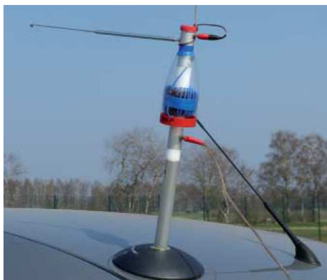
Fot. 7.2.2. Stopa magnetyczna. Widoczna na zdjęciu antena teleskopowa służy do precyzyjnego dostrojenia anteny na niższych pasmach. Antena pokrywa całkowicie pasma wyższe 40 i 20 m z WFS poniżej 1,5 i nie wymaga w nich dostrajania
