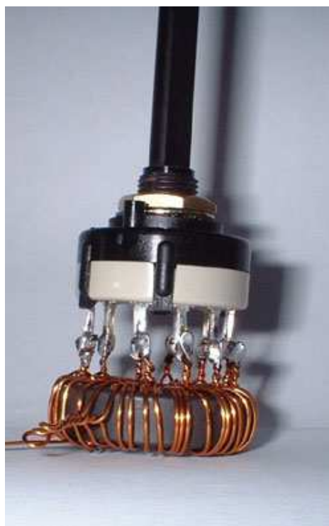
Fot. 3.4.5 a i b. Szczegóły wykonania cewki i połączenia z przełącznikiem. Cewka jest nawinięta na ferrytowym rdzeniu pierścieniowym FT114-61
