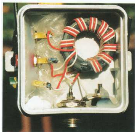
Fot. 2.2.15. Przykład wykonania transformatora kwadryfilarnego nawiniętego kablem płaskim
