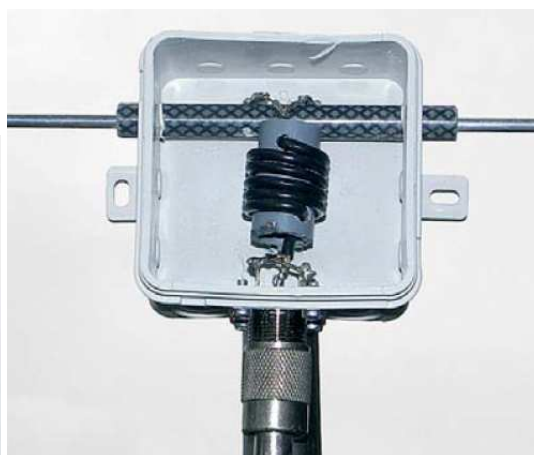
Rys. 9.22.4. Skrzynka przyłączeniowa anteny na pasmo 2 m z dławikiem
