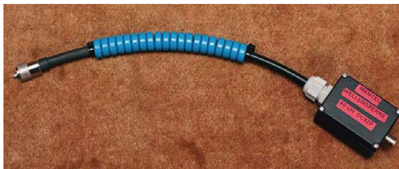
Fot. 2.3.7. Dławik złożony z 20 rdzeni pierścieniowych FK20 nawleczonych na kabel współosiowy. Typ rdzenia zależy od średnicy kabla
