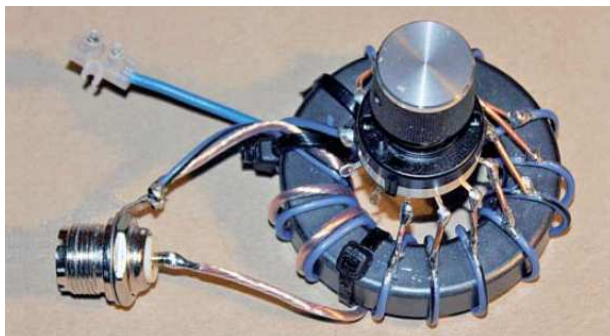
Fot. 2.2.20. Transformator magnetyczny z obrotowym przełącznikiem odczepów
