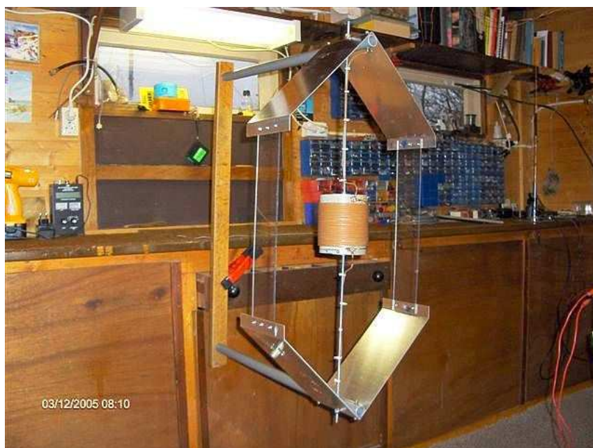
Fot. 2.9.2. Antena „Isotron” konstrukcji PA0UNT i PA1AMS
