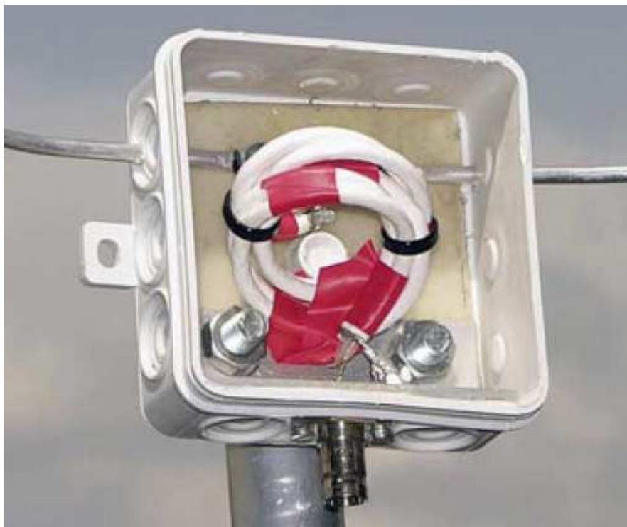
Fot. 9.20.2. Skrzynka przyłączeniowa z transformatorem dopasowującym
