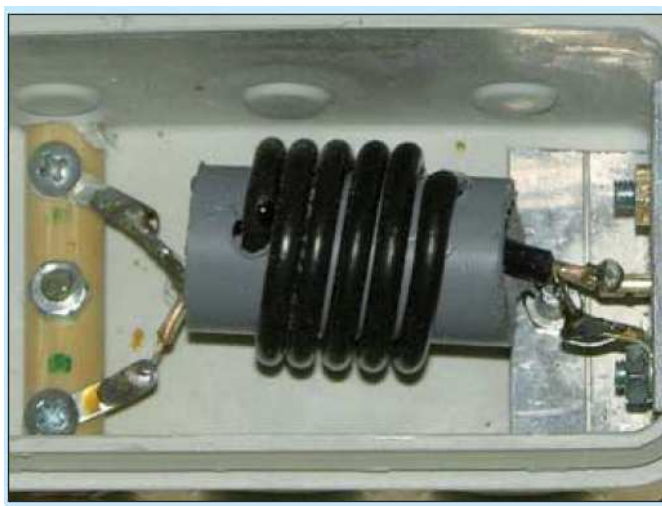
Fot. 2.3.6. Dławik na pasmo 2 m nawinięty kablem RG-174. Dopuszczalna obciążalność – 100 W
