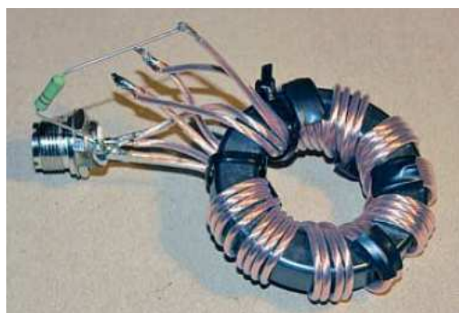
Fot. 2.2.18. Kwadryfilarny transformator magnetyczny o trzech przekładniach na rdzeniu FT240-43 obciążony opornikiem na czas pomiarów (źródło „Funkamateur” 4/2015)
