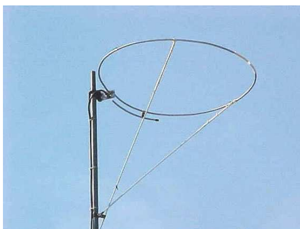
Rys. 9.20.11. Konstrukcja anteny „Halo” z transformatorem gamma na pasmo 50 MHz
