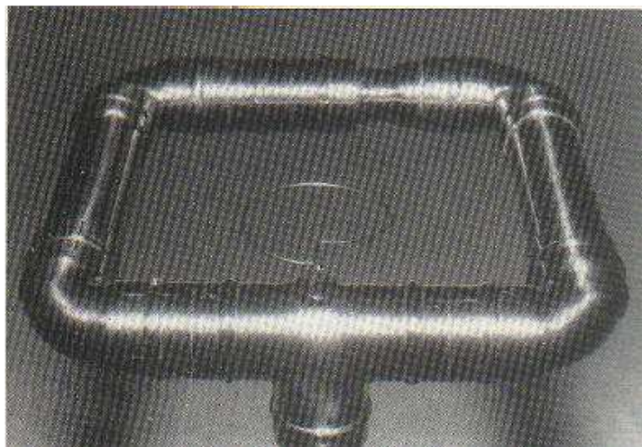
Fot. 9.2.2. Widok anteny w położeniu poziomym – promieniowana jest fala o tej samej polaryzacji
