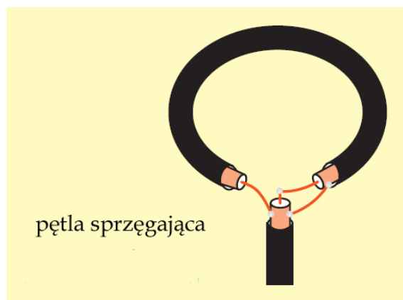
Rys. 5.6.3. Połączenia pętli sprzęgającej. Miejsca lutowań należy zaizolować
