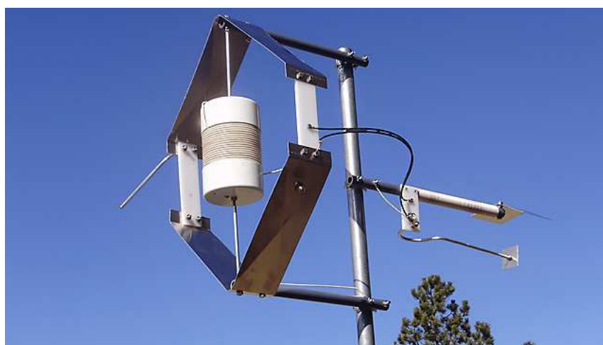
Fot. 2.9.1. Antena typu „Isotron” na pasma 20 i 40 m
