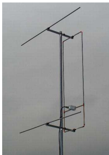
Rys. 9.5.6. Reflektorowa antena szczelinowa na 144 MHz
