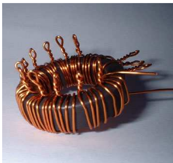
Fot. 3.4.5 a i b. Szczegóły wykonania cewki i połączenia z przełącznikiem. Cewka jest nawinięta na ferrytowym rdzeniu pierścieniowym FT114-61
