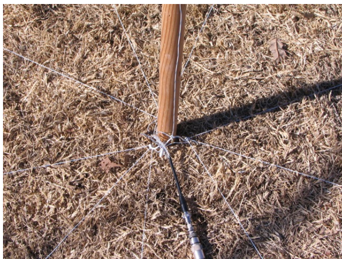
Fot. 8.1.10. Konstrukcja przeciwwag
