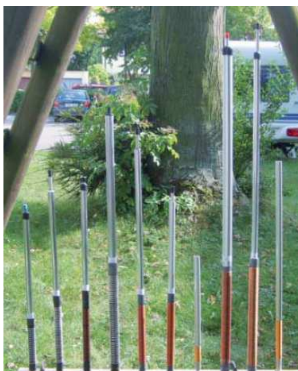
Fot. 7.1.2. Seria anten „Mini-Mob”. Po lewej stronie anteny dla pasm 10 do 17 m, po prawej trzy wykonania dla pasma 40 m i na środku antena dla pasma 20 m
