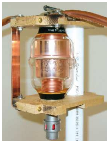
Fot. 5.6.4. Kondensator próżniowy o wysokim napięciu przebicia
