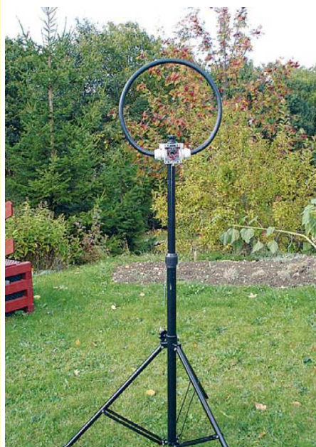
Fot. 5.7.2. Antena o średnicy 0,39 m na pasmo 20 m
