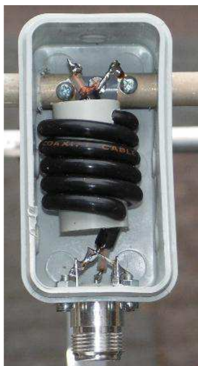
Rys. 9.5.5 a i b. Szczegóły konstrukcji skrzynki przyłączeniowej i rurkowej anteny na 144 MHz
