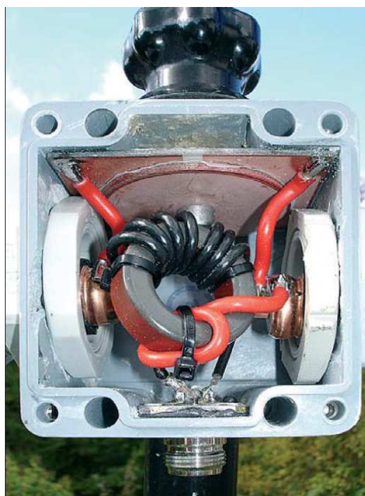
Fot. 5.7.3. Transformator zasilający antenę na 20 m. U góry widoczny kondensator motylkowy własnej roboty
