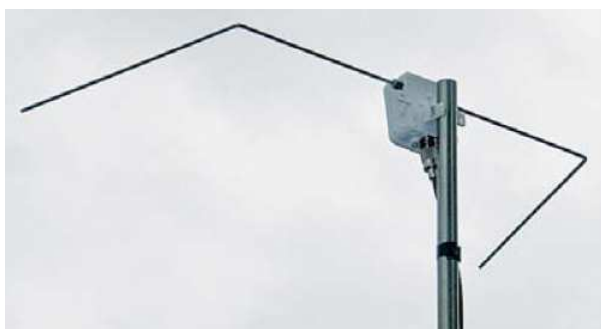
Fot. 9.22.3. Dipol załamany na pasmo 2 m
