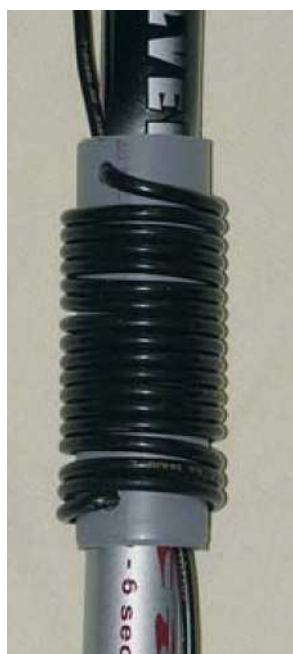
Fot. 2.3.5. Dławik powietrzny KF powstały przez nawinięcie kabla na rurce plastikowej
