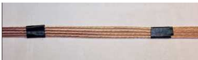
Fot. 2.2.17. Cztery przewody licy 1,5 mm 2 w izolacji teflonowej sklezione taśmą przygotowane do nawinięcia uzwojenia kwadryfilarnego transformatora magnetycznego (źródło „Funkamateur” 4/2015)
