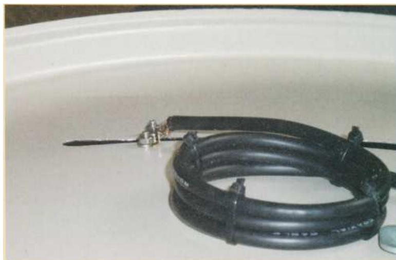
Rys. 9.4.1. Antena szczelinowa wykonana z czaszy satelitarnej
