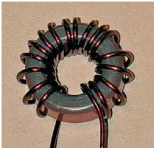
Fot. B.3. Sposób nawinięcia 17,5 zwoja
