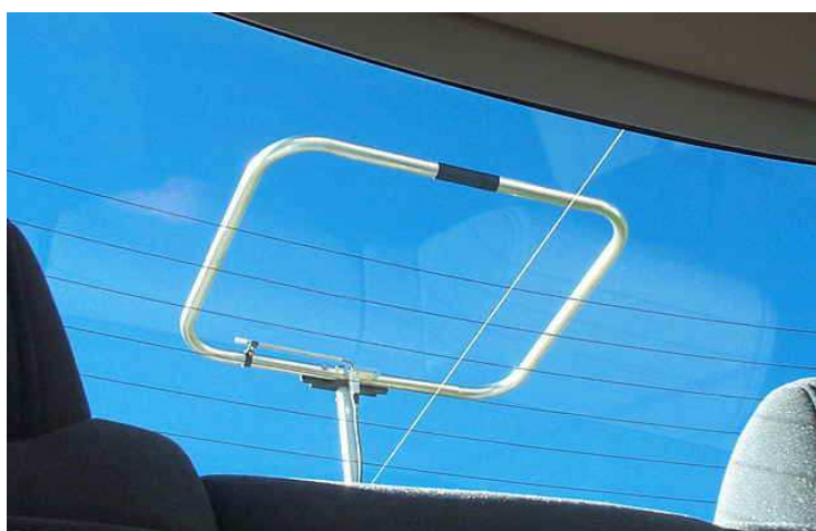
Fot. 9.20.10. Prostokątna antena „Halo” z transformatorem gamma wykonana z rurki aluminiowej
