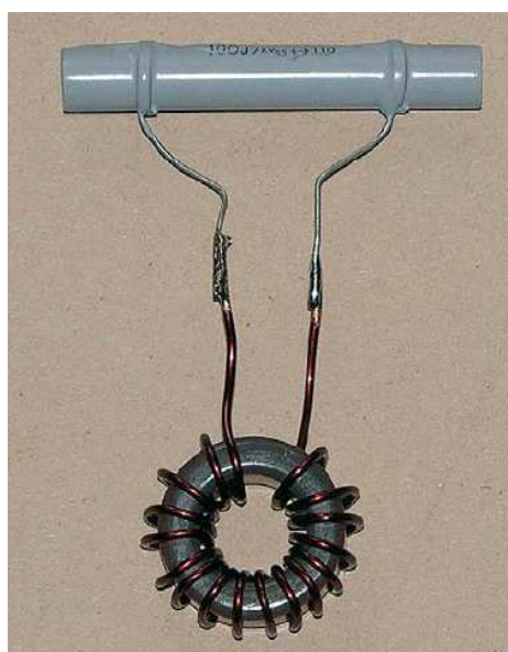
Fot. B.2. Obwód na 10,1 MHz z pojedynczym kondensatorem
