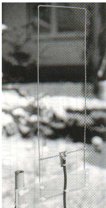
Rys. 9.5.2. Antena na pasmo 430 MHz
