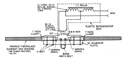
FRONT VIEW OF DRIVEN ELEMENT 2 ELEMENT 40 M HELICAL BEAM
