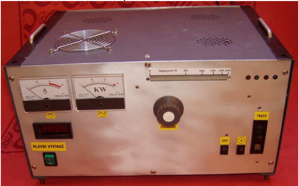
Obr.12 Finální provedení výkonového zesilovače.
