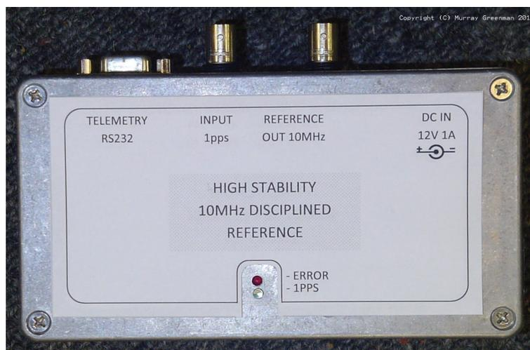
Fig. 49. The Simple GPSDO
